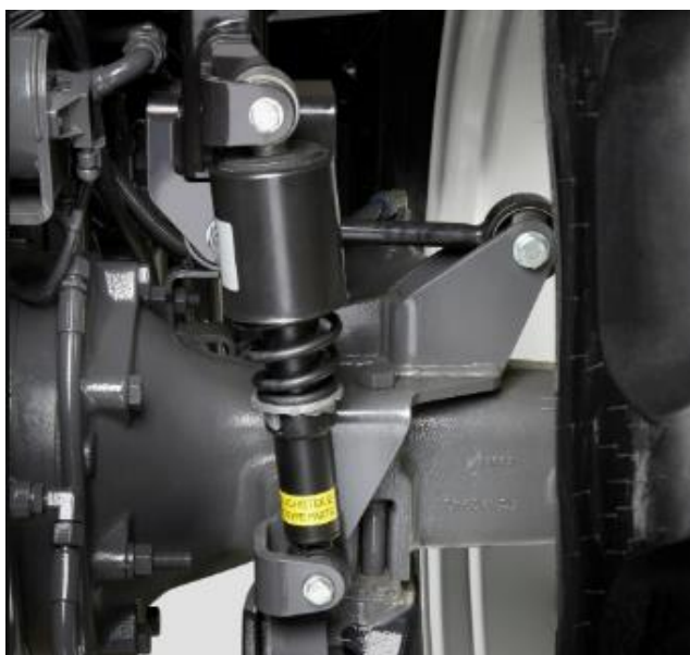
Figura 3.9 esempio di ammortizzatore per cabine
