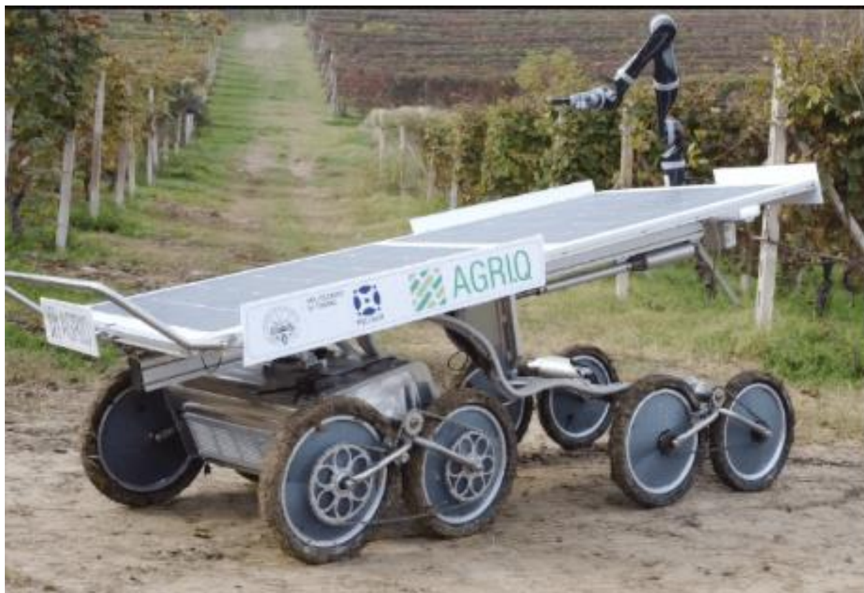
Figura 2.5 Agri Q. [19] con sospensioni attive
