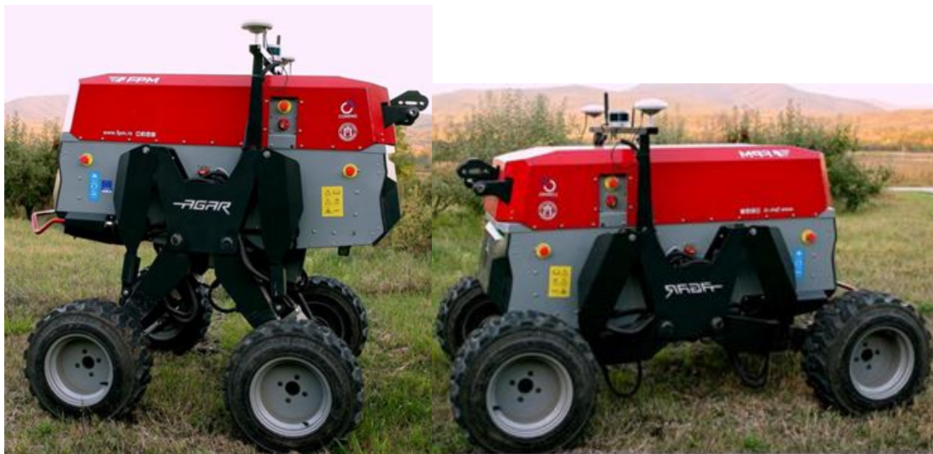
Figura 2.6 AgAR [20] con sospensioni ibride, massima altezza a sx, minima a dx
