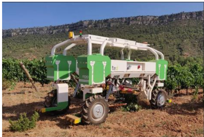
Figura 2.3 rover BoniRob [15] a sx, Ted Naio [16] a dx, sospensioni rigide
