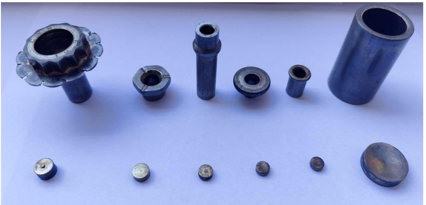
Figura 3 – esempi di semilavorati forati prodotti in azienda senza ancora nessuna lavorazione successiva (Stefano)
