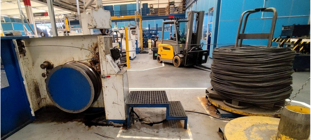
Figura 11 - percorso filo nella trafila per entrare in macchina (CVB, Tabbia Stefano)
