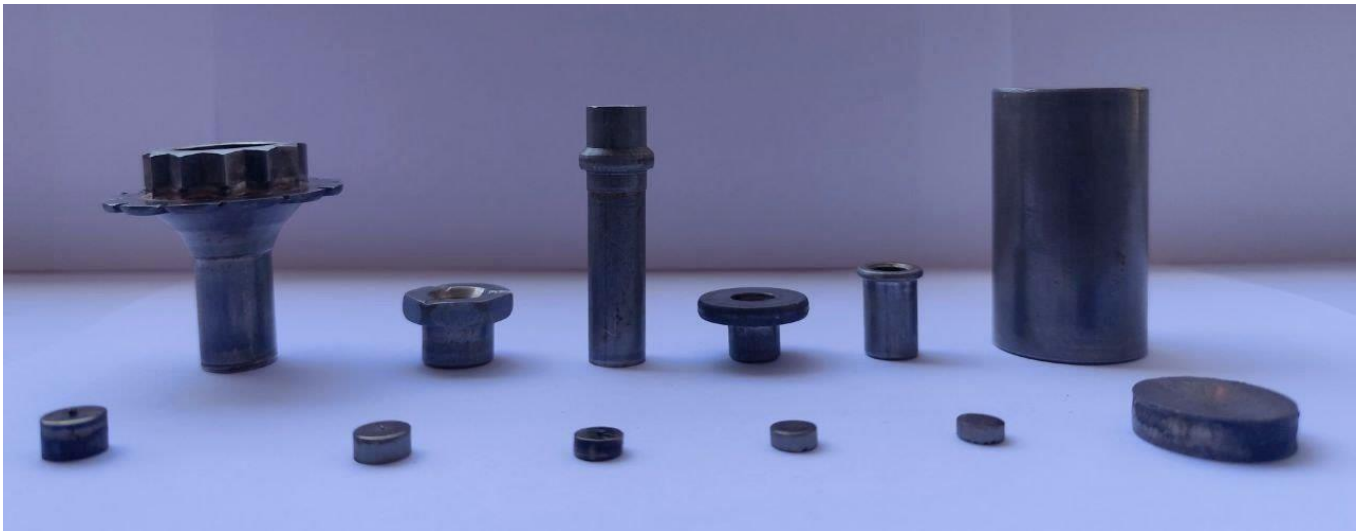
Figura 2 - esempi di semilavorati forati prodotti in azienda senza ancora nessuna lavorazione successiva (Stefano)
