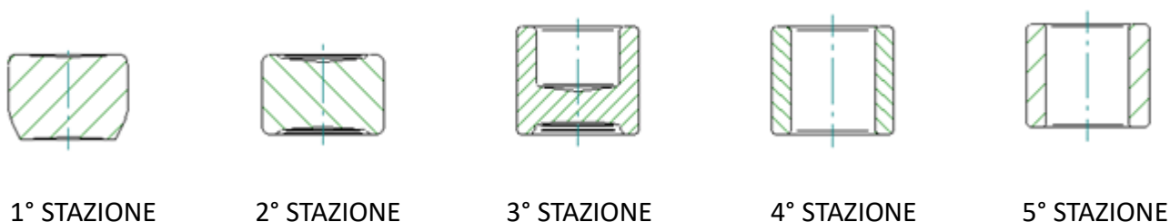
Figura 6 - Ciclo di stampaggio di una boccola forata (AGRATI-CVB)
