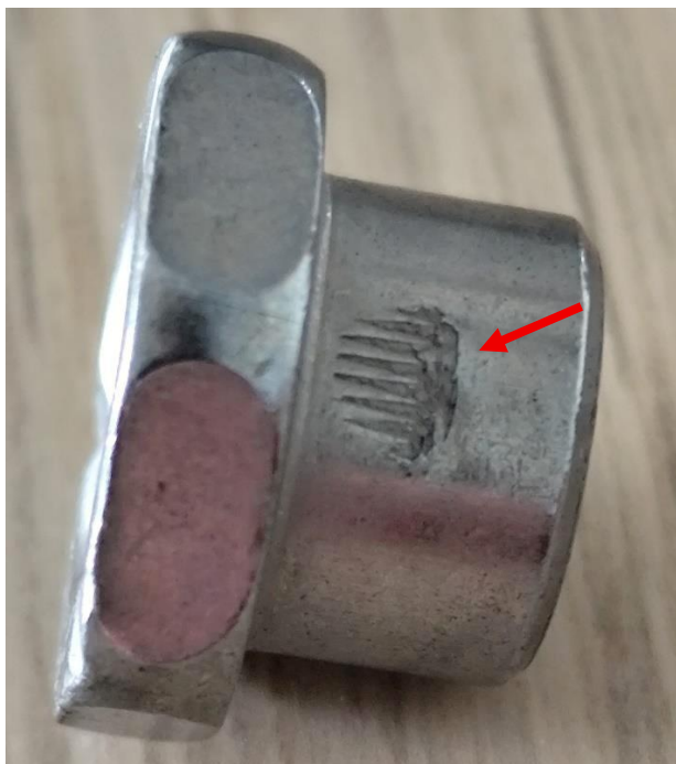
Figura 34 – tacchetta per coppia serraggio (CVB, Tabbia Stefano)
