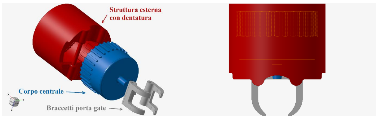
FIGURA 45: REDESIGN GRIPPER PER LA MOVIMENTAZIONE DEI CANALI DI ALIMENTAZIONE
