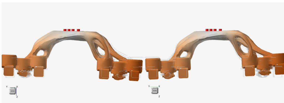
FIGURA 121: MODO DI VIBRARE A 105,691 Hz
