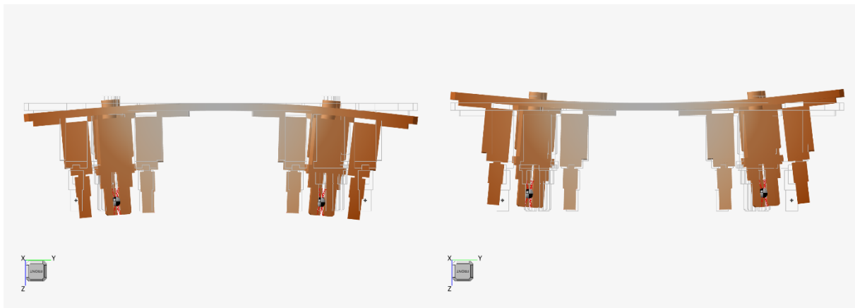
FIGURA 37: MODO DI VIBRARE 91.2463 Hz
