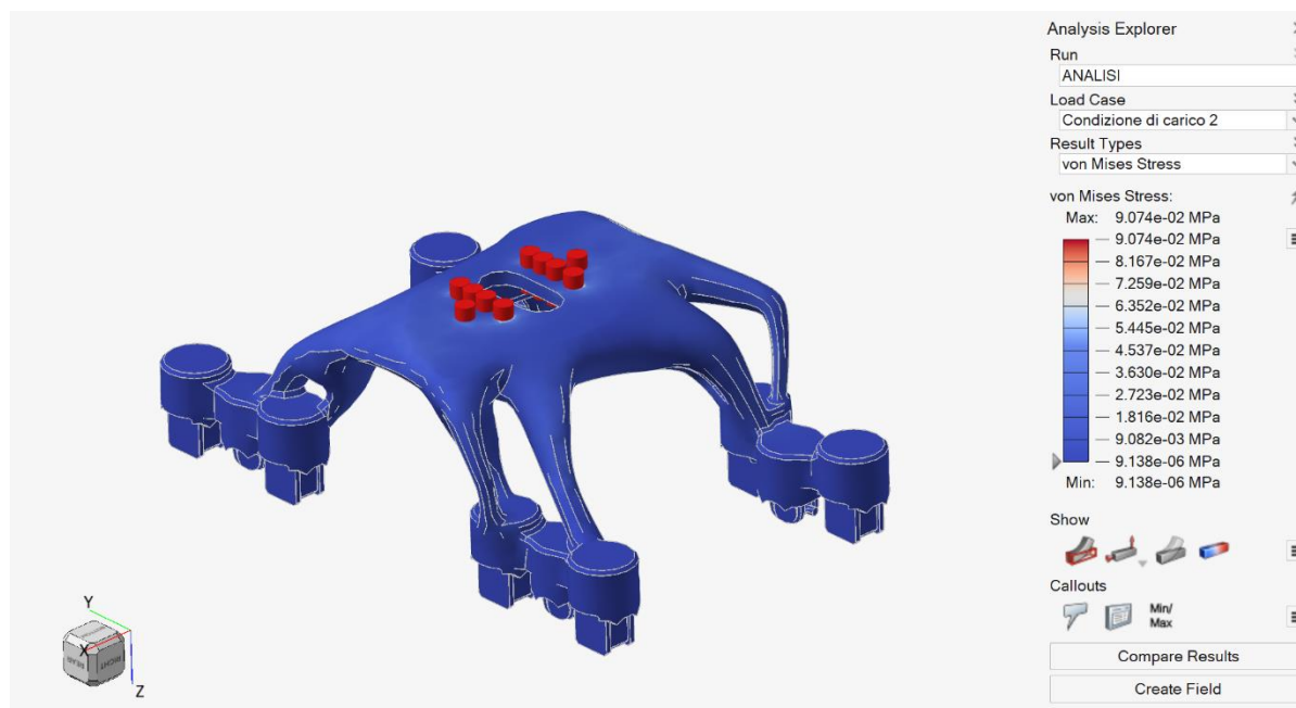
FIGURA 118: DISTRIBUZIONE DELLE TENSIONI EQUIVALENTI DI VON MISES
