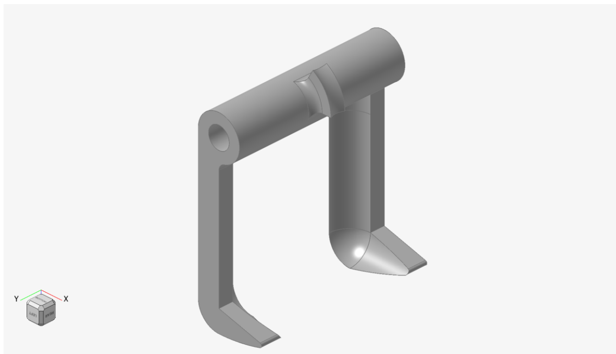
FIGURA 90: GEOMETRIA FINALE BRACCETTO PORTA GRIPPER
