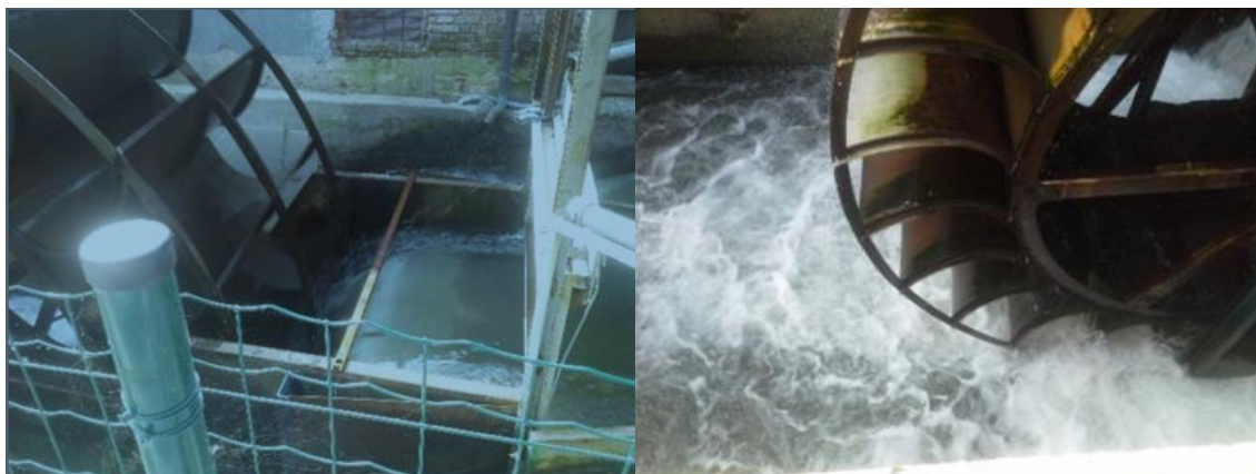
Figura 29: a sinistra è riportato un esempio di ruota idraulica con una progettazione inadeguata dell'afflusso e della forma delle pale. Nella figura a destra è riportato un esempio di ruota idraulica con un deflusso mal progettato nel canale di scarico [25]
