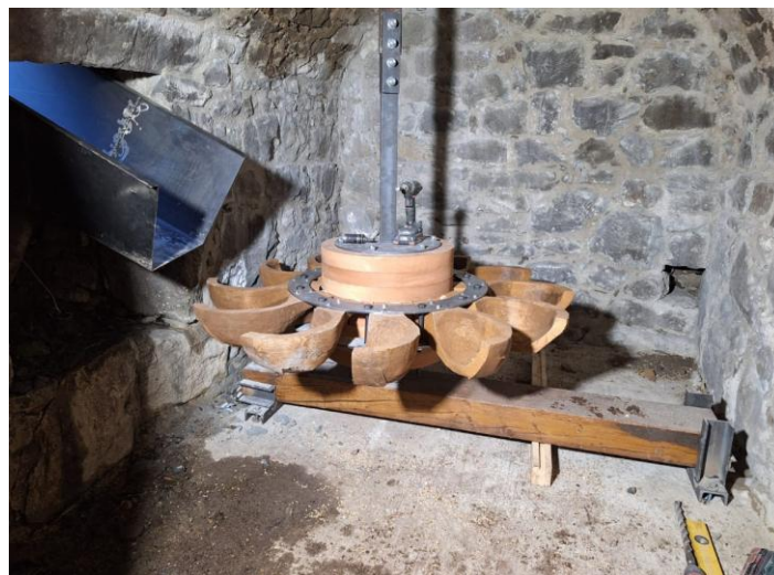
Figura 32: pale della girante del mulino di Civago a seguito dell'intervento di recupero [33]
