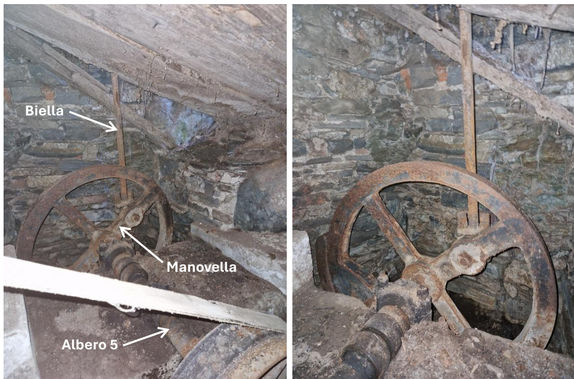
Figura 53: fotografia del meccanismo biella-manovella che riporta la ruota calettata sull'"albero 5" (la manovella) e la biella
