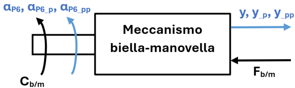
Figura 102: diagramma di corpo libero del meccanismo biella-manovella
