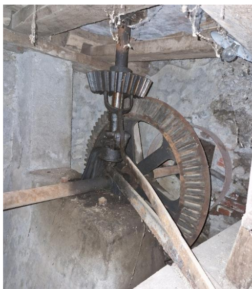
Figura 40: meccanismo per la trasmissione del moto alle macine (in particolare, questo è quello della terza macina)
