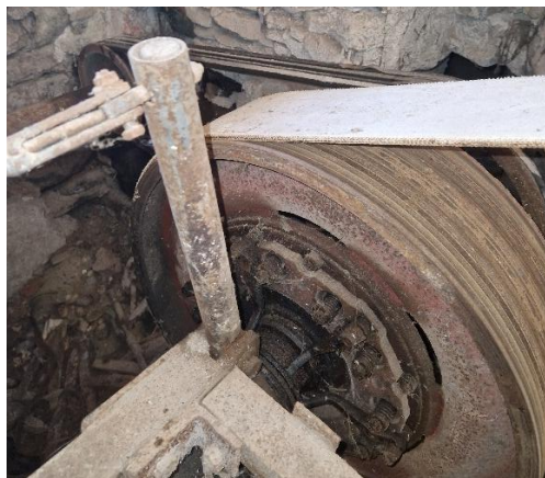
Figura 39: innesto a frizione per la trasmissione del moto alla segheria
