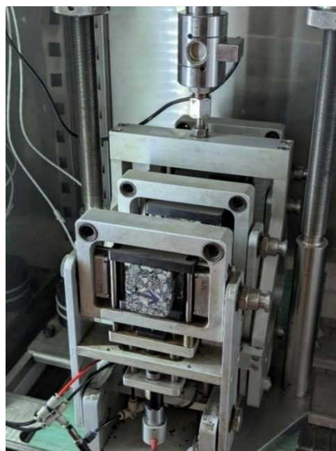
Figura 27: Test di fatica in configurazione 4PB
