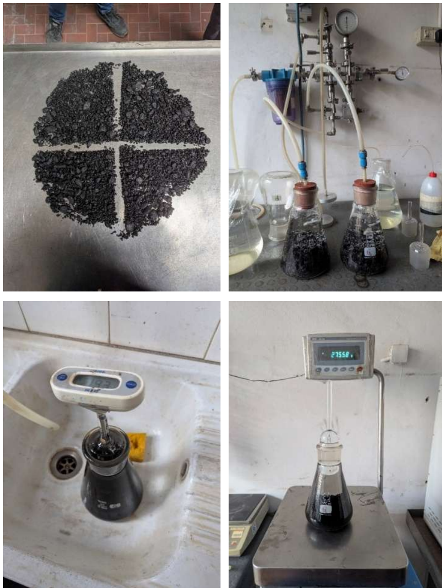
Figura 19: Fasi della misurazione della TMD con metodo del picnometro
