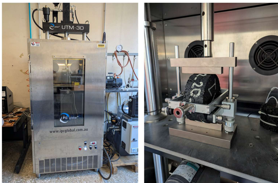
Figura 23: Esecuzione della prova in configurazione IC-CY
