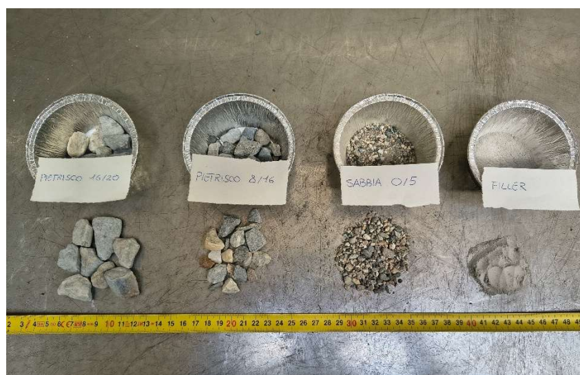
Figura 13: Classi granulometriche aggregati vergini
