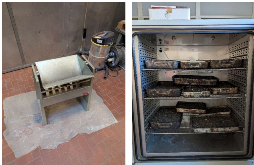
Figura 17: Dispositivo utilizzato per quartatura e condizionamento del RAP in cella climatica
