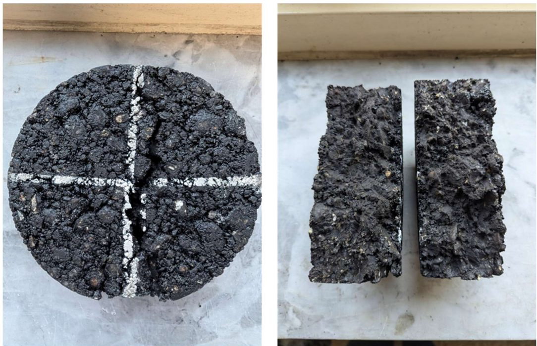
Figura 31: Provino giunto a rottura in un test di fatica in configurazione IT
