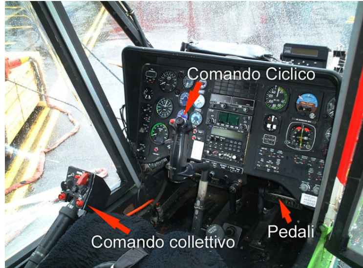
Figura 1.1: Schema dei comandi di volo primari di un elicottero [50].
