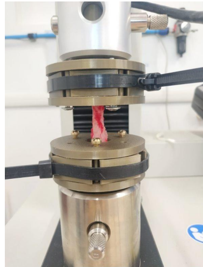
Figura 4.3: Test a trazione condotto su campioni di forma rettangolare ottenuti incidendo longitudinalmente il bronco (A). Test a trazione condotto con il sistema di afferraggio sviluppato per testare i campioni in configurazione cilindrica (B).
