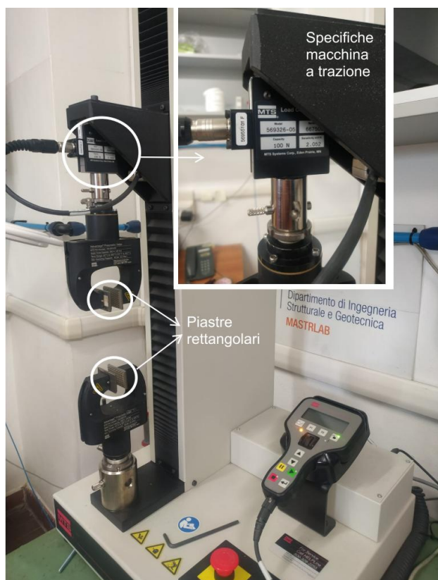
Figura 4.5: A sinistra vengono evidenziate le specifiche della macchina a trazione e come vengono posizionate le piastre rettangolari sulle ganasce. A destra, invece, si può osservare la strumentazione con un campione di bronco posizionato: Il meccanismo di chiusura delle piastre rettangolari è controllato da un sistema a pressione che serra le ganasce. Nei cerchi sono evidenziati i due fili che garantiscono l'accoppiamento tra il sistema di pressione e le ganasce.
