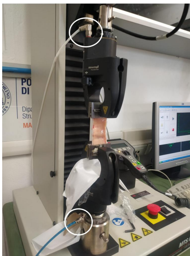
Figura 4.5: A sinistra vengono evidenziate le specifiche della macchina a trazione e come vengono posizionate le piastre rettangolari sulle ganasce. A destra, invece, si può osservare la strumentazione con un campione di bronco posizionato: Il meccanismo di chiusura delle piastre rettangolari è controllato da un sistema a pressione che serra le ganasce. Nei cerchi sono evidenziati i due fili che garantiscono l'accoppiamento tra il sistema di pressione e le ganasce.
