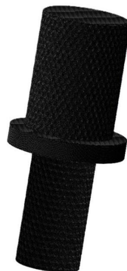
Figura 4.6: Rappresentazione CAD del sistema di afferraggio con un tassello inserito (A). Cilindro interno realizzato con la rugosità superficiale a forma di nido d'ape. Per ottimizzare le tempistiche del processo di stampo, ciascun cilindro presenta due misure differenti a seconda del diametro del bronco da testare (B).
