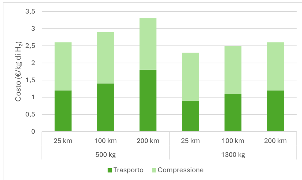
Figure 16: Costi di trasporto e Compressione dell'idrogeno molecolare per capacità del t e distanza percorsa. Fonte: Department for Energy Security and Net Zero, Hydrogen Transport and Storage Cost Report (London: UK Government, 2023).
