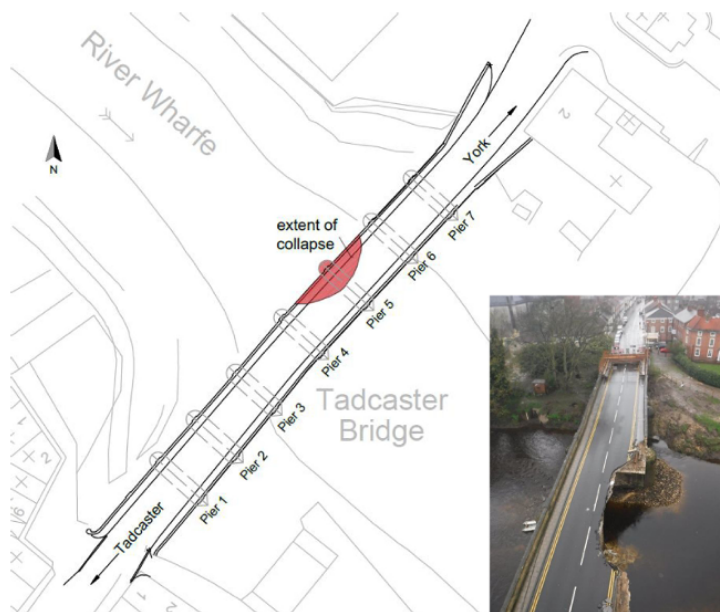
Figura 3.2: Schema del ponte che mostra la porzione crollata in rosso relativa al quinto pilone; in basso a destra, una foto del ponte dopo il collasso successiva al ritirarsi della piena del fiume [10].
