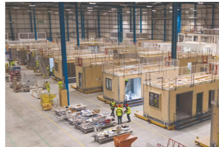
Interno dello stabilimento dedicato alla produzione di moduli abitativi tridimensionali completi, che integrano struttura, involucro e finiture, pronti per il trasporto e l'assemblaggio in cantiere.
