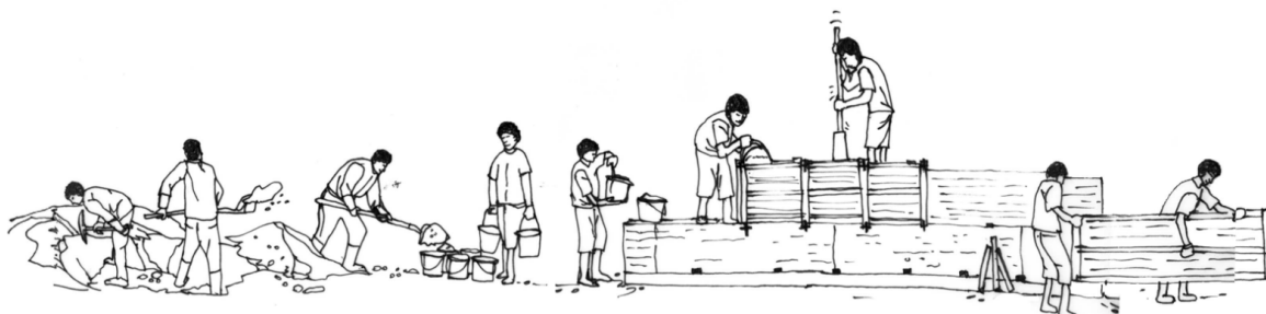
Fig. 6 Tecnica tradizionale della terra battuta Fonte: https://madeinearth.in/topics/techniques/rammed-earth/
