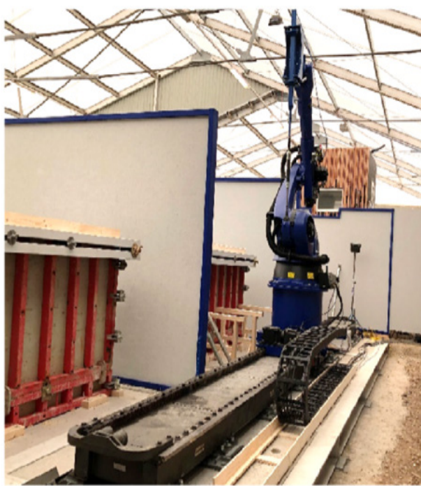
Fig. 19 Sistema di prefabbricazione robotica ERNE. Fonte: https://www.sciencedirect.com/science/article/pii/S0959652623007278?via%3Dihub
