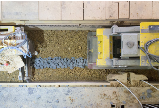
Fig. 116 Immagine di produzione dei blocchi di pareti con Roberta Fonte: https://www.lehmtonerde.at/en/projects/project.php?plD=97
