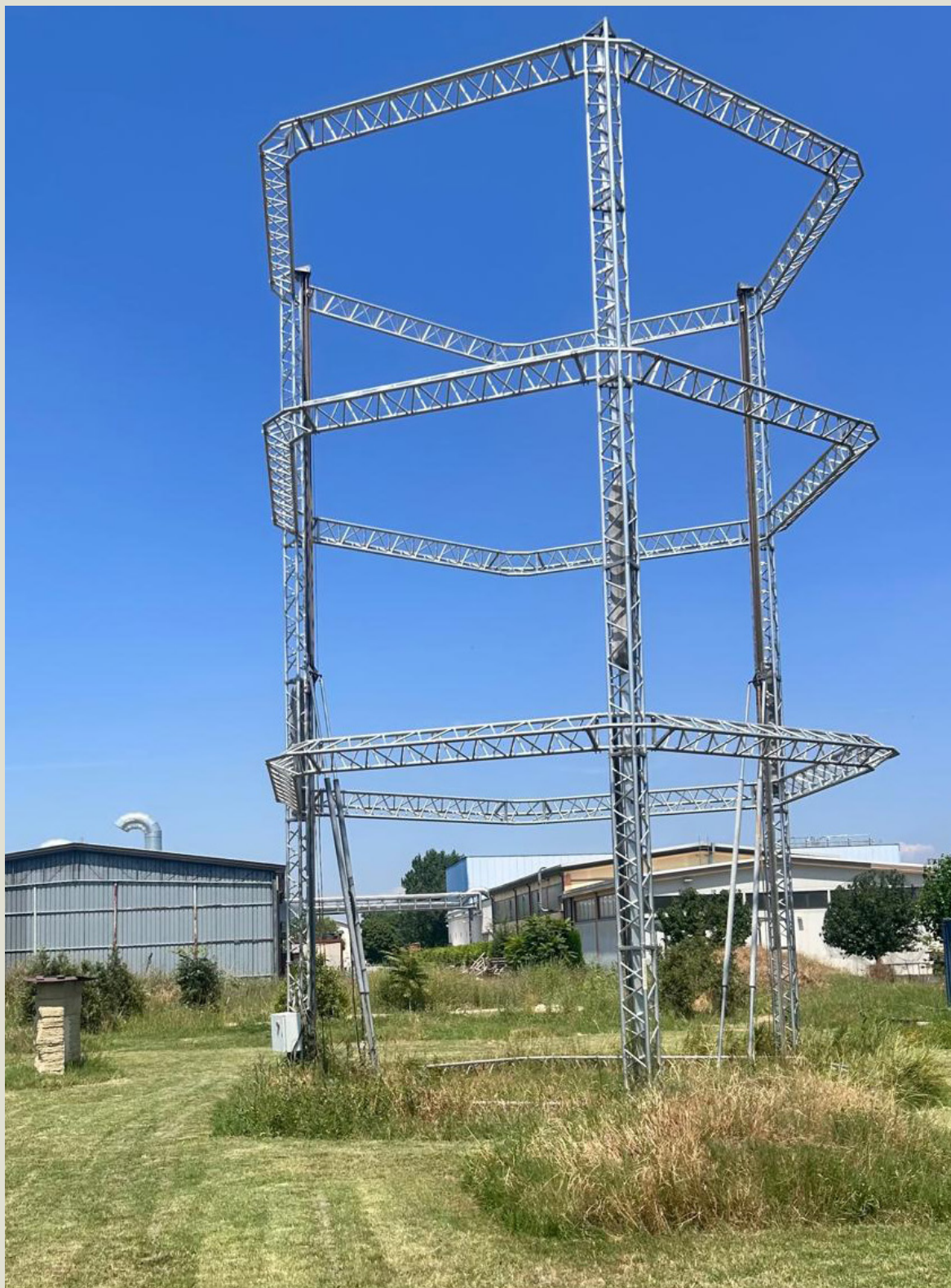
Fig 35. Fotografia di Big Delta 12 m ubicata in sede di Wasp a Massa Lombarda. Immagine scatta dall'autore
