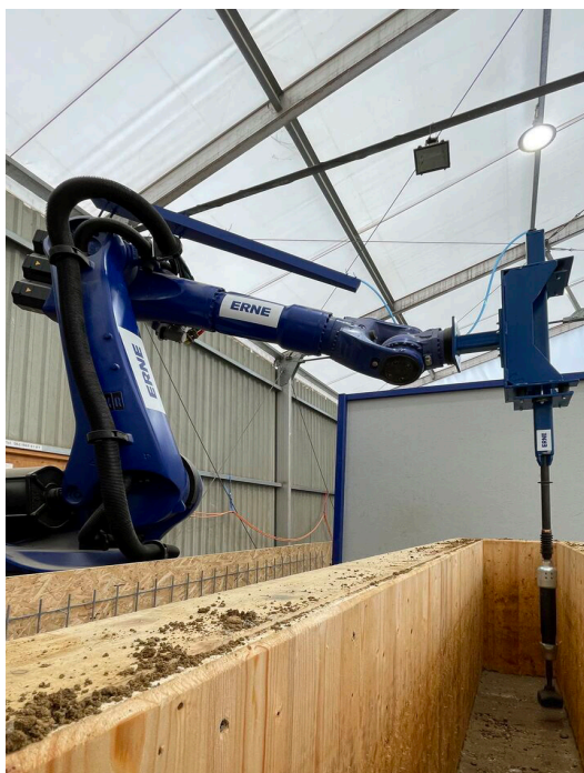
Fig. 18 Sistema di prefabbricazione robotica ERNE. Fonte: https://www.linkedin.com/posts/erne-ag-holzbau_lehmbau-robotik-vorfertigung-activity-6948243066323402752-Rnoe/?originalSubdomain=de
