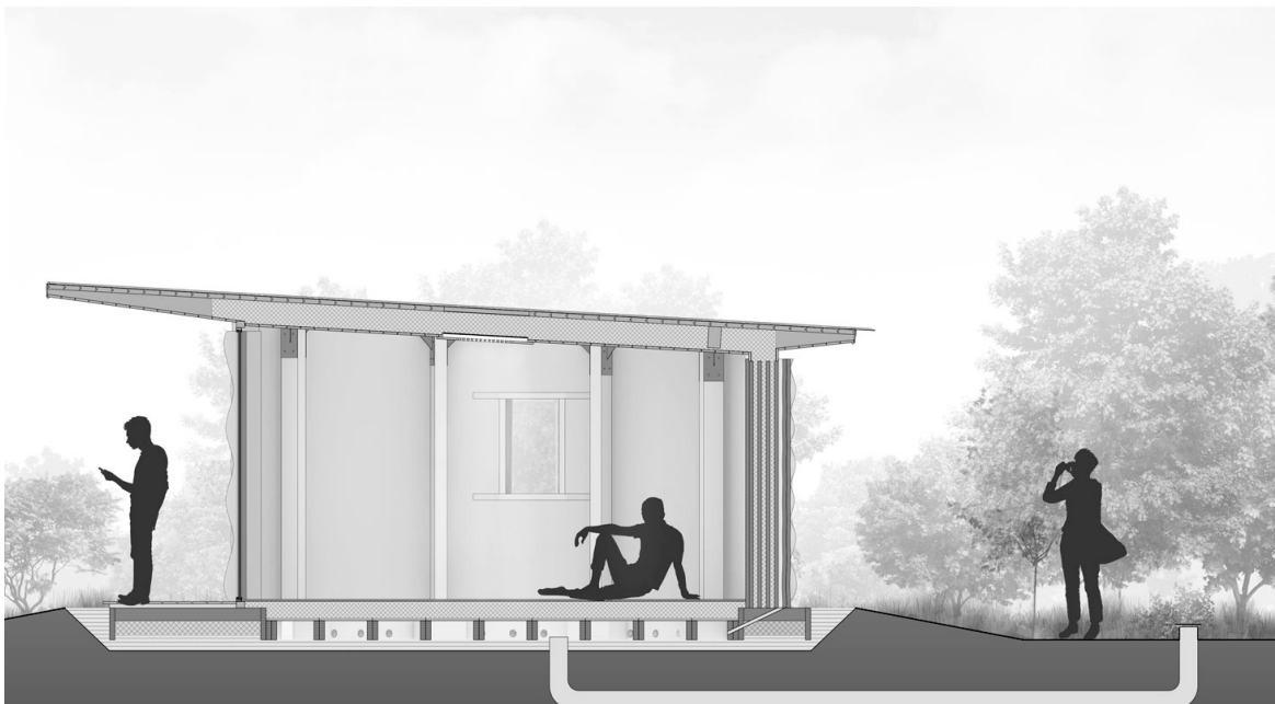
Fig.126 Sezione trasversale del modulo stampato GAIA. Rappresentazione fuori scala. Rappresentazione tratta da: https://www.3dwasp.com/casa-stampata-in-3d-tecla/
