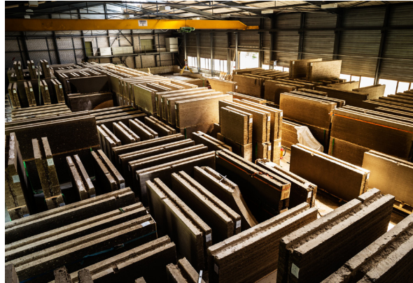
Fig. 104. Pannelli in terra tagliati nel formato 4,35x1,35,0,45. https://www.baunetzwissen.de/
