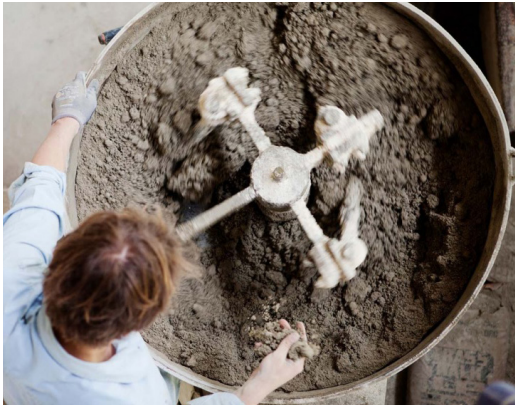
Fig. 101. Miscela dell'impasto di terra. https://www.lehmtonerde.at/en/projects/project.php?plD=87
