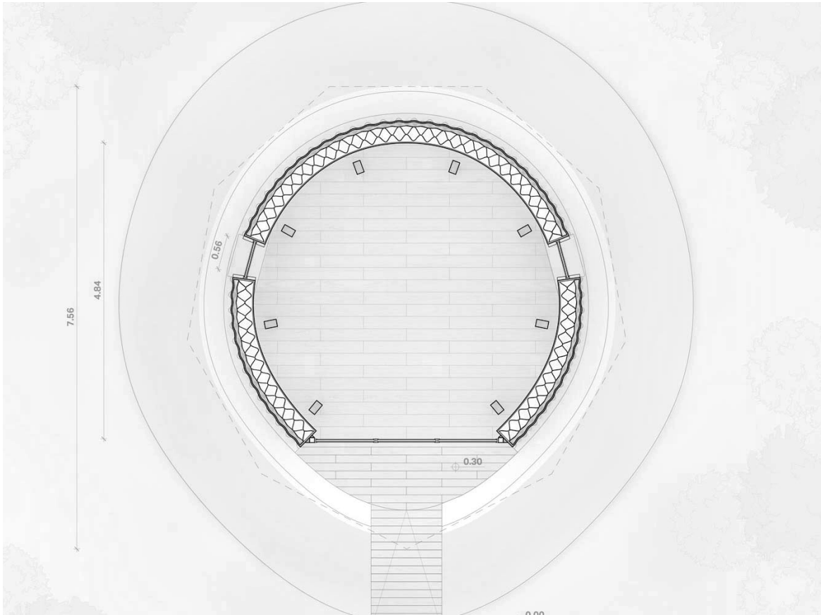
Fig.125 Planimetria del modulo stampato GAIA. Rappresentazione fuori scala. Rappresentazione presa da: https://www.3dwasp.com/casa-stampata-in-3d-tecla/
