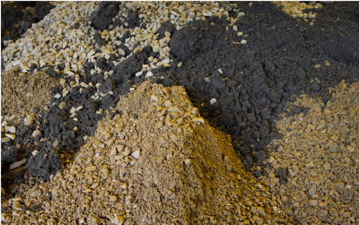
Fig. 97 I materiali utilizzati nella miscela di terra per la prefabbricazione dei blocchi. Foto: https://www.haascookzemmrh.com/en/rojekte/alnatura-campus-en/
