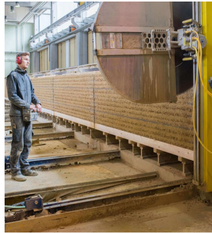
Fig. 15 Macchina di taglio verticale. https://cradle-mag.de/artikel/martin-rauch-einzigartige-projekte-aus-stampflehm.html
