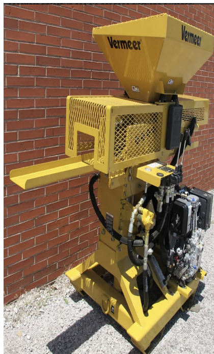
Fig. 10 Macchina semi automatica per blocchi ceb. Fonte: https://www.popsci.com/technology/article/2013-05/building-blocks/
