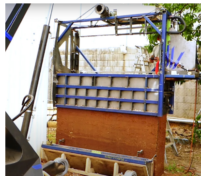
Fig. 17 Sistema di prefabbricazione Form Earth. Fonte: https://www.sciencedirect.com/science/article/pii/S0959652623007278?via%3Dihub
