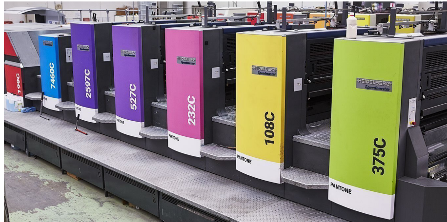
I castelli di colore di un macchinario di stampa offset, dove è possibile aggiungere dei Pantone oltre alla quadricromia CMYK
