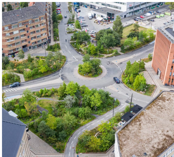
Fig.4.10: La piazza Skt. Kjelds Plads dopo la trasformazione: alberature diffuse, superfici verdi e bacini di infiltrazione. Fonte: SLA Architetti / Comune di Copenaghen (2018).
