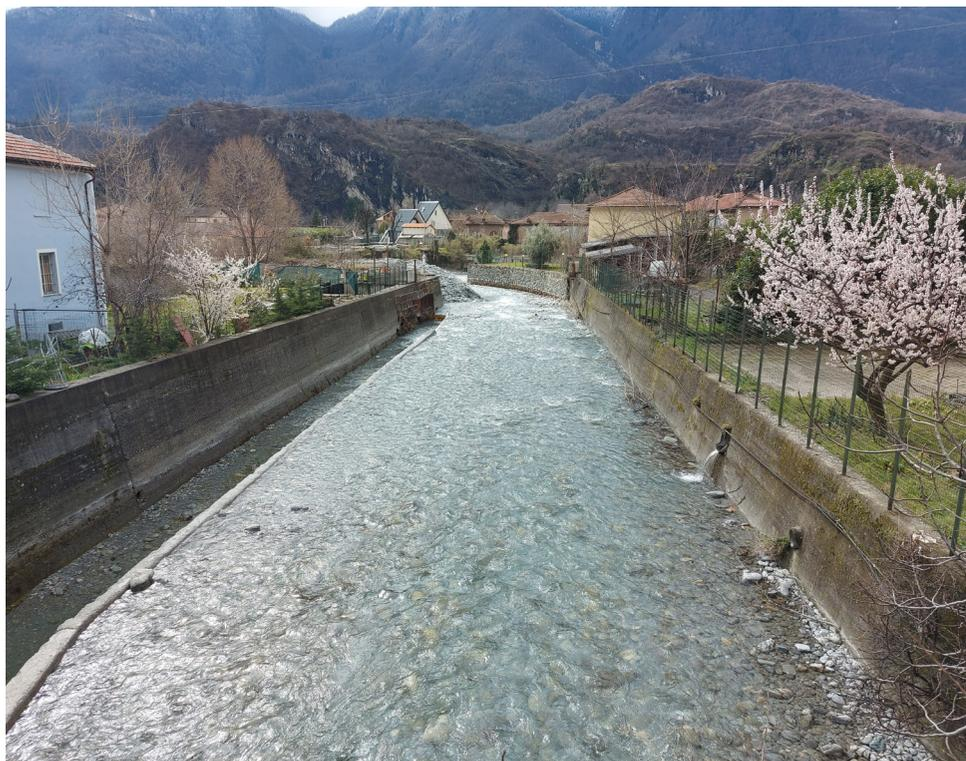
Fig.4.A.19 - Veduta del torrente Cenischia nei pressi della confluenza con la Dora Riparia; si notano le opere di arginatura previste dal Piano regolatore.
