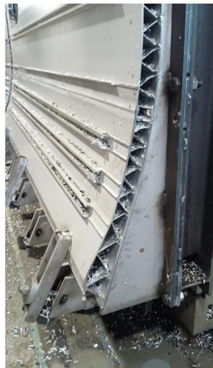
**Figure 5.24:** Dima di fresatura della fiancata nella realtà
