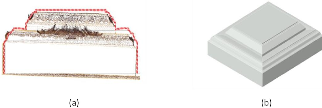
Figura 27 (a) sezione di una specchiatura del soffitto cassettonato, l'elaborazione mostra il confronto tra la profilazione rigida di *Autodesk Revit* e la nuvola di punti, evidenziandone le discrepanze.; (b) rappresentazione tridimensionale finale del soggetto, ottenuta tramite modellazione tradizionale con profilo su percorso.
