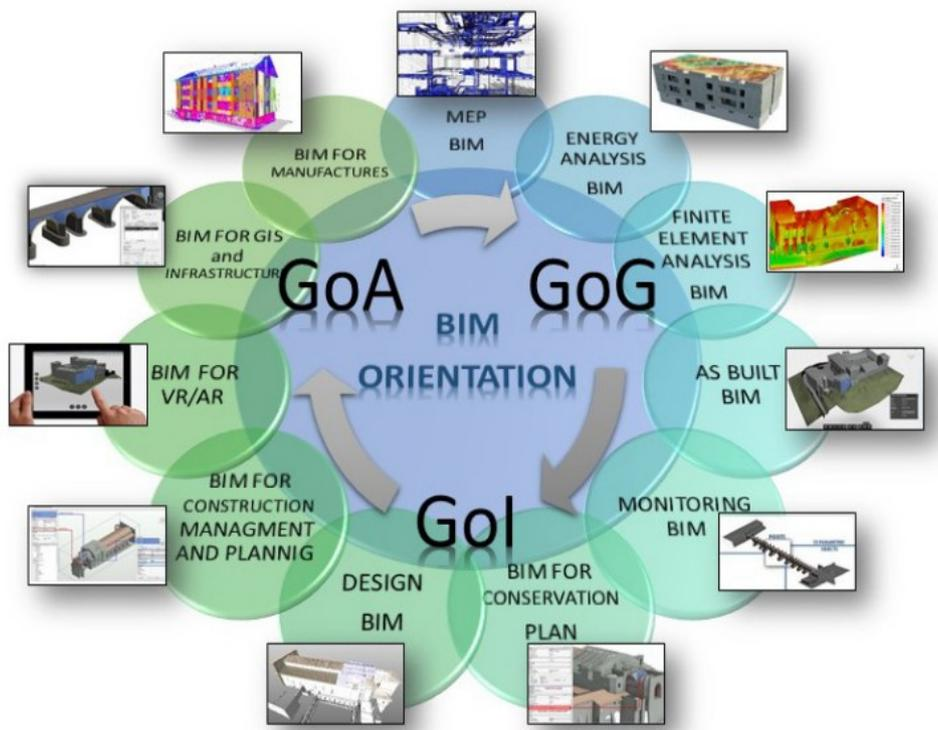
Figura 8 Orientamento del modello BIM secondo i parametri GoG, GoA e GoI, in funzione della disciplina e del tipo di analisi. Fonte: (Banfi, 2017; Banfi, 2019)
