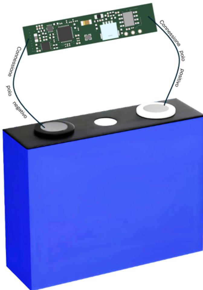
**Figura 4.6:** Montaggio su cella prismatiche
