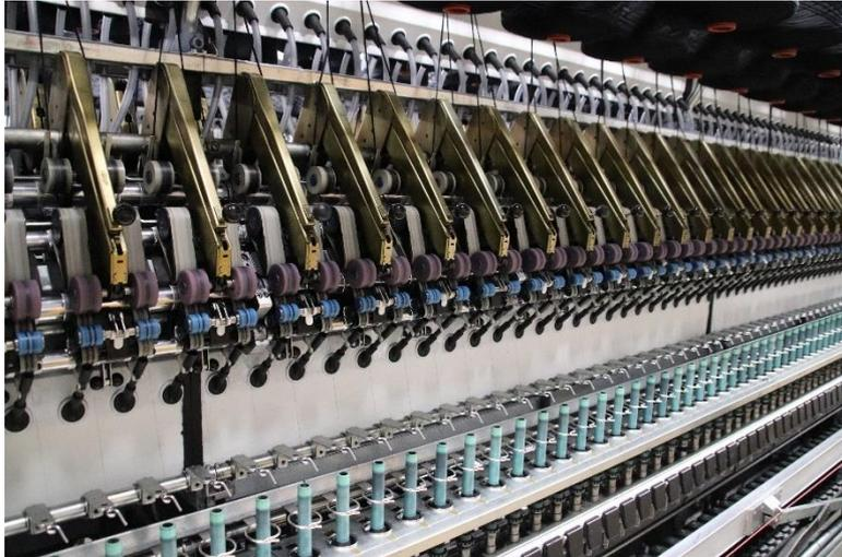
**Figura 4.6:** Un macchinario per la filatura ad anello (fotografia dell'autore, visita a Successori Reda)
