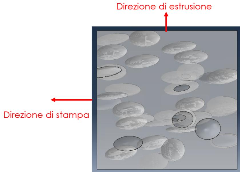
Figura 3.12: RVE porosità 10%, orientamento vuoti
