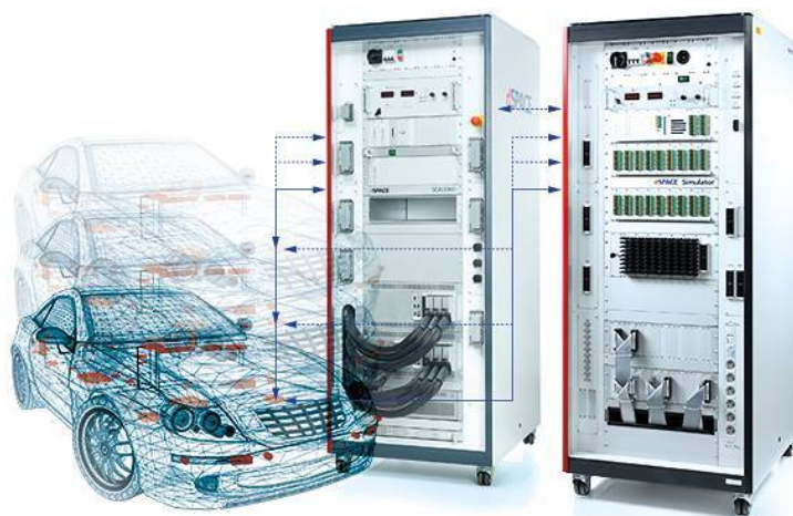
Figura 3.22: Applicazioni HIL per apparati powertrain.
