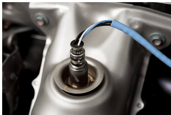
Figura 3.7: Sensore - Sonda lambda di ossigeno.
