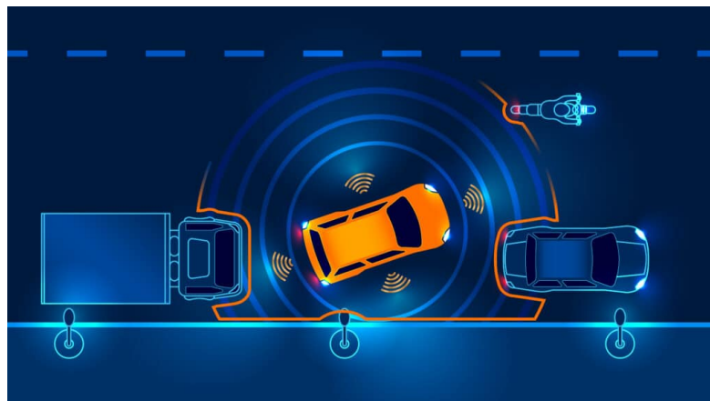
Figura 3.4: Sistemi ADAS per funzioni di park assist.
