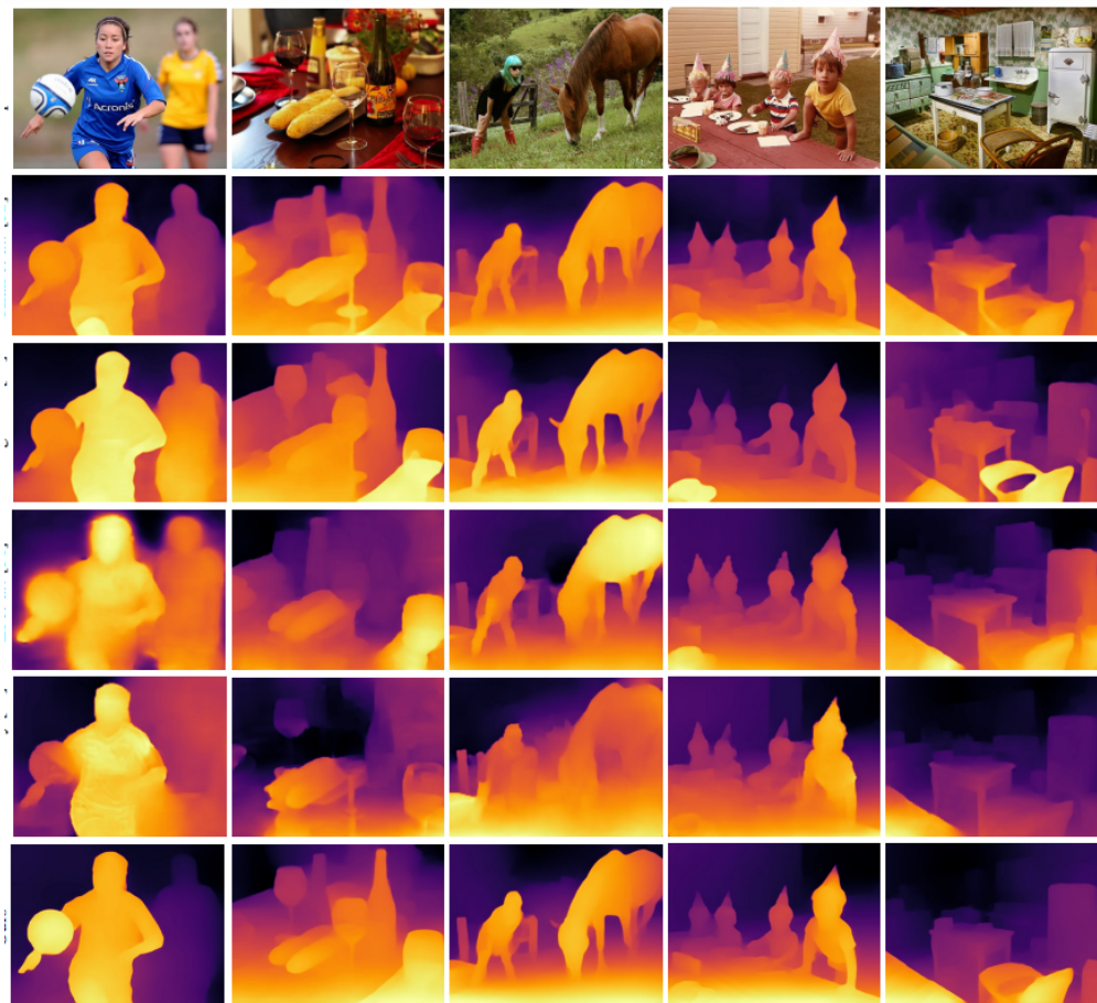
Figura 3.27: Confronto qualitativo di MiDaS ai quattro migliori concorrenti sulle immagini dal dataset Microsoft COCO [47]. Dall'alto verso il basso: immagini di input, Xian et al. [56], Wang et al. [57], Li et al. [65], Li & Snavely [54] e MiDaS [5].
