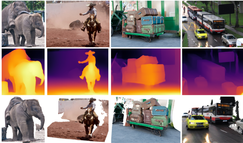
Figura 3.26: In alto: immagini di input. Al centro: mappe di profondità inversa previste da MiDaS. In basso: corrispondenti point cloud renderizzati da un nuovo punto di vista, renderizzate tramite Open3D [66]. Immagini di input dal dataset Microsoft COCO [47], che non è stato visualizzato durante l'addestramento.[5]
