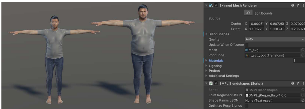
Figura 3.7: Visualizzazione dello stesso modello SMPL con parametri di forma differenti, gestiti dal componente SMPLBlendshapes .
