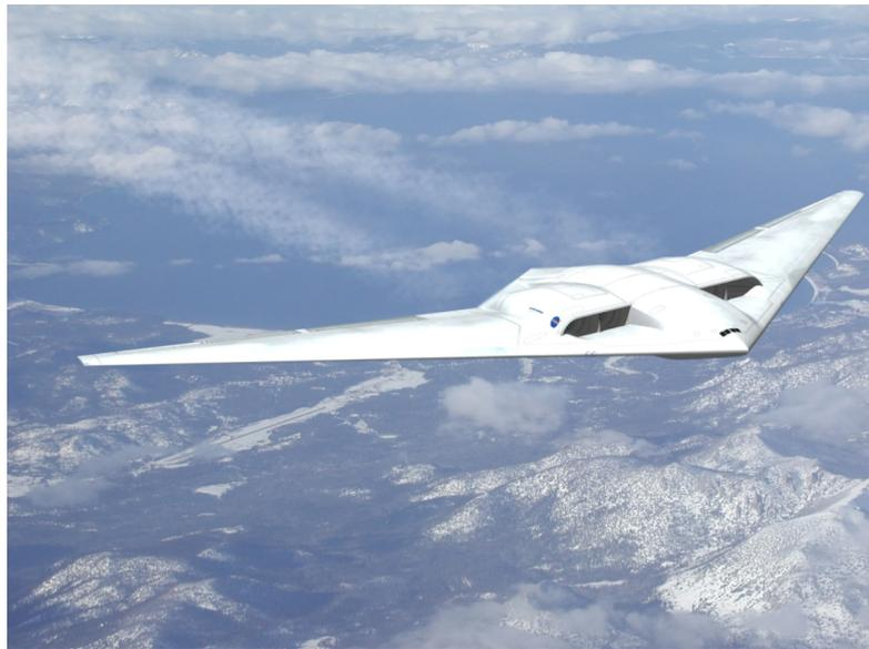
**Figure 1.3:** Rendering della configurazione Blended Wing-Body [12].
