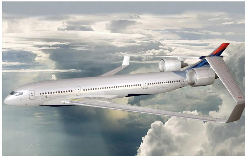
Figure 1.5: Rendering di un aereo commerciale ad ala chiusa [26].
