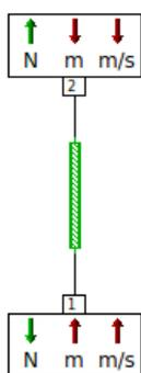
MECROPE0: Questo modello permette di considerare l'interasse tra i vari componenti rotativi, date le sensibili distanze non trascurabili. Questo approccio evita le limitazioni derivanti da un collegamento diretto, implementando invece un sistema massa – molla – smorzatore per simulare le dinamiche della fune. Tale configurazione permette di considerare la cedevolezza della fune e i gradi di libertà definiti dalla quantità di nodi (masse) selezionati.
