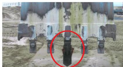
Figura 2.14: Utensile rimozione tubo [4]
