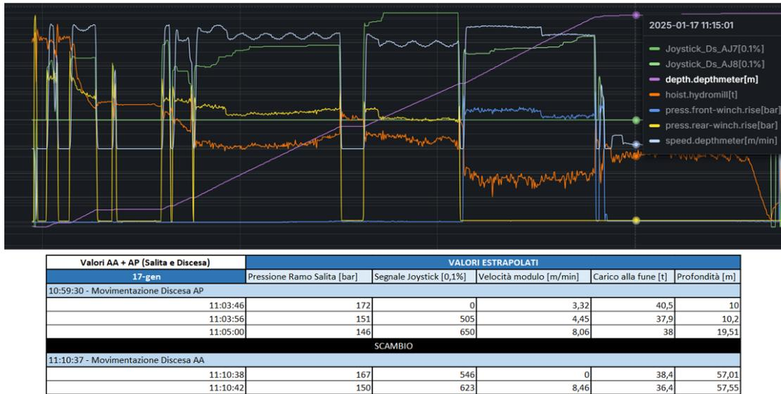
**Figura 4.41:** Monitoraggio [12] ed estrapolazione dati DMS per fase di discesa unità fresante
