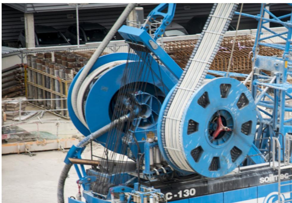
**Figura 2.54:** Tubo fango (sn) tubi idraulici (dx) [7]
