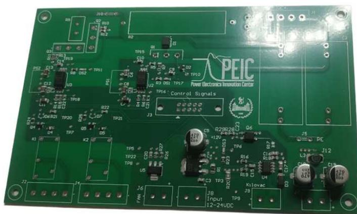
Figura 5.6: Scheda di Servizio dopo Posizionamento Componenti SMD.
