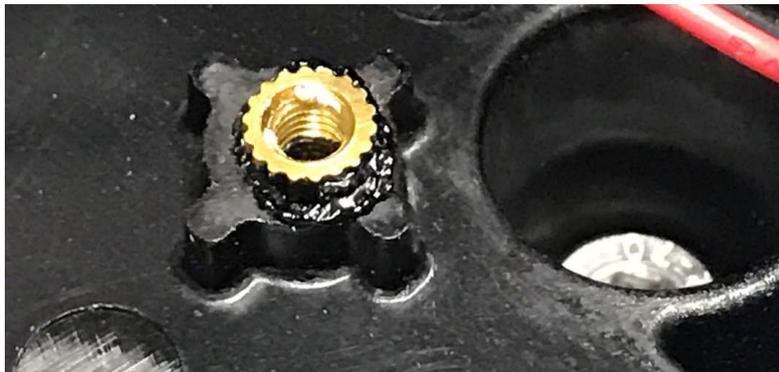
Figura 5.27: Particolare dell'Inserto Filettato Montato sul kit Wolfspeed.
