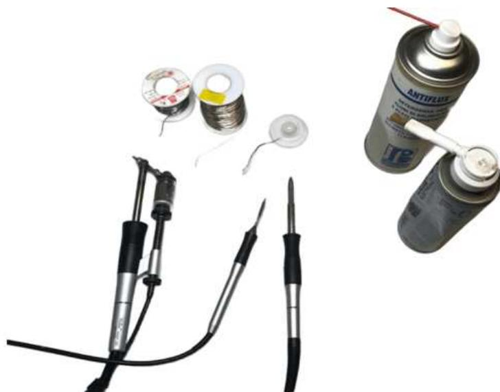
Figura 5.9: Strumenti Utilizzati per Processo di Saldatura Componenti THT.
