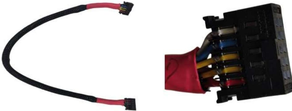
Figura 5.18: Cavo e Connettore per scambio Segnali DC Side Board e Control Board.
