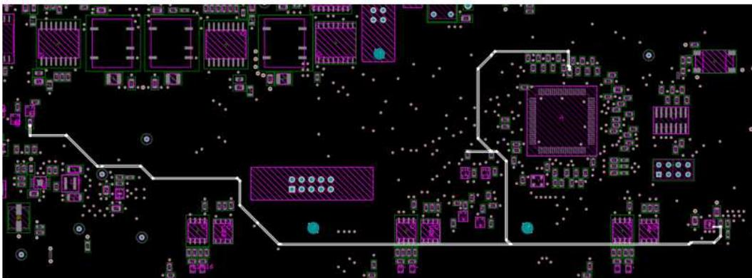
Figura 2.24: Percorso del Segnale PG\_3V3A.
