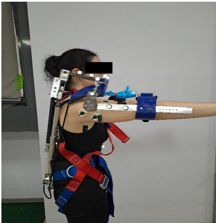
*Figura 3.15 Foto illustrativa del posizionamento dei marker*
