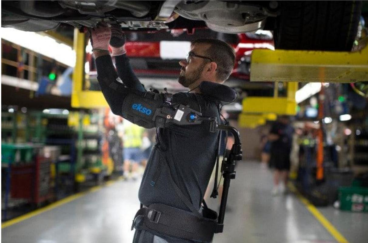
*Figura 1.9 EksoVest indossato da un lavoratore Ford (Fonte: [14])*
