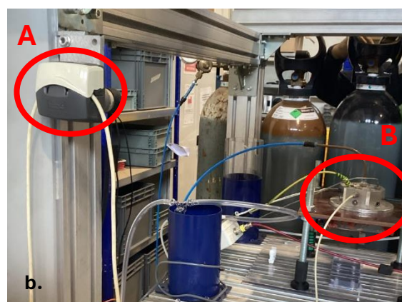
Figura 31 b. Dettaglio della pompa peristaltica (A) Connessione della pompa peristaltica alla camera di reazione (B).
