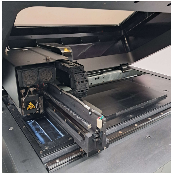
Figura 2.22: Vassoio di stampa della stampante Objet30.
