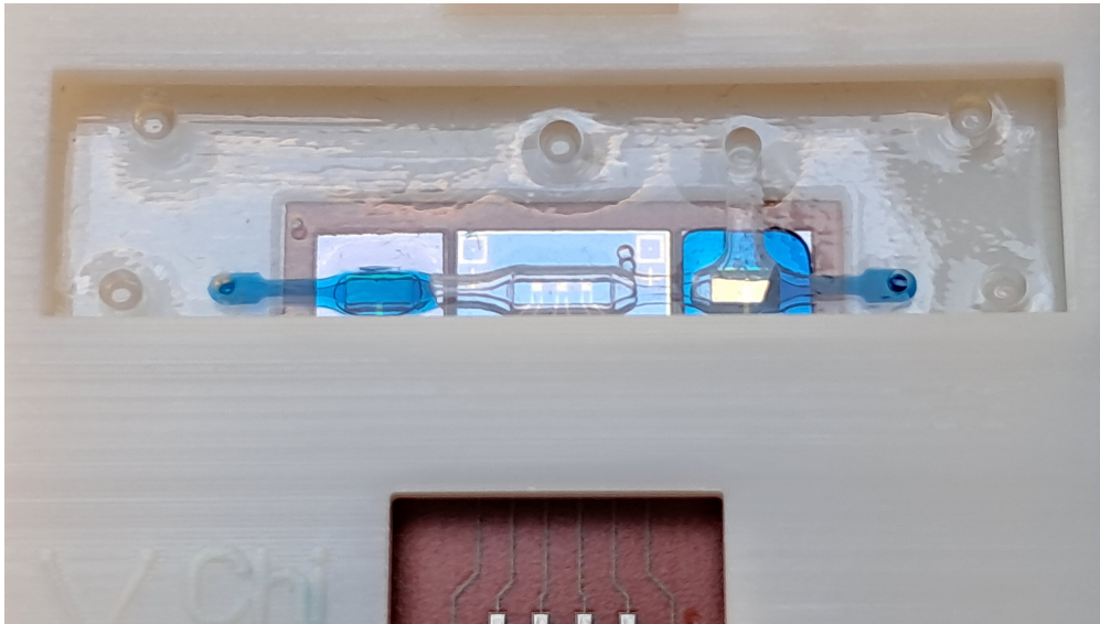
Figura 3.14: Piattaforma assemblata tramite plasma bonding, con il liquido blu all'interno.
