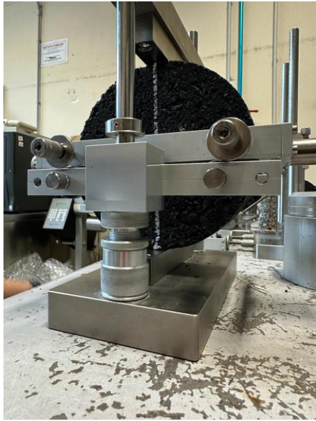
Figura 50: posizionamento del provino all'interno del castelletto di prova
