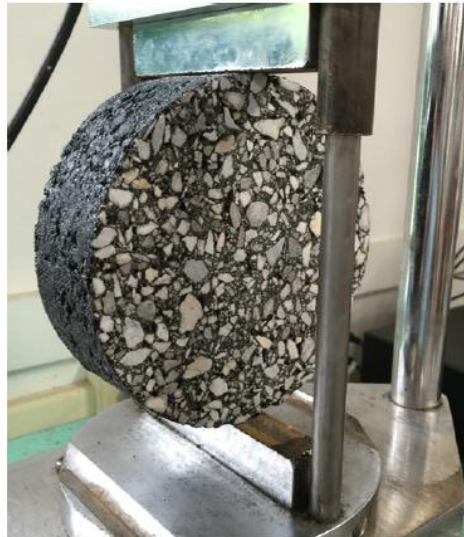
Figura 52: configurazione della prova a trazione indiretta
