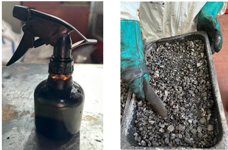
Figura 18: rejuvenator utilizzato e miscelazione RAP + rejuvenator
