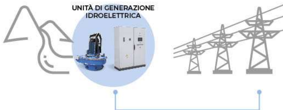
Figura 52: Turbine idroelettriche certificate CEI 0-21 [29]
