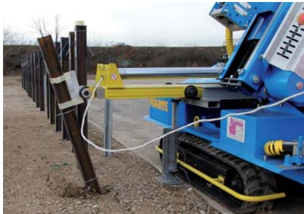
Figura 28: Esempio di prova per la determinazione della resistenza del terreno (CAMPO PROVA)
