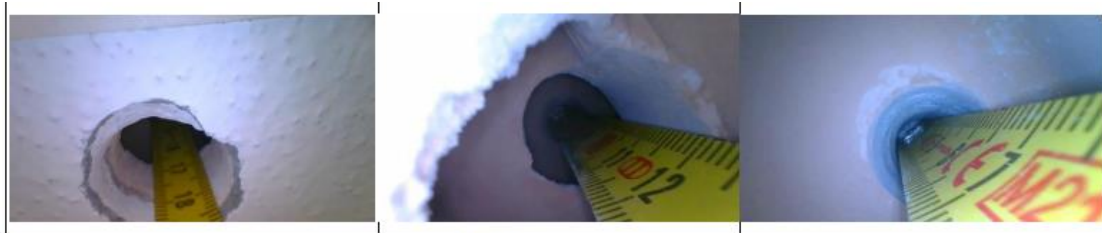
Immagini stratigrafia intradosso solaio – Pignatta b 12 cm
