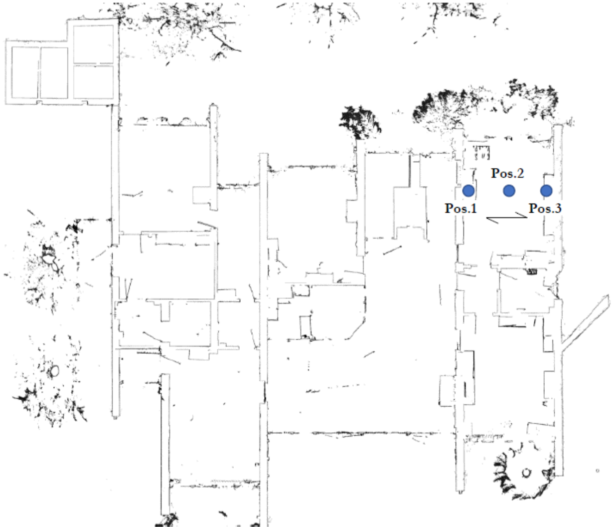
Figure 149 – Ubicazione della prova di carico
