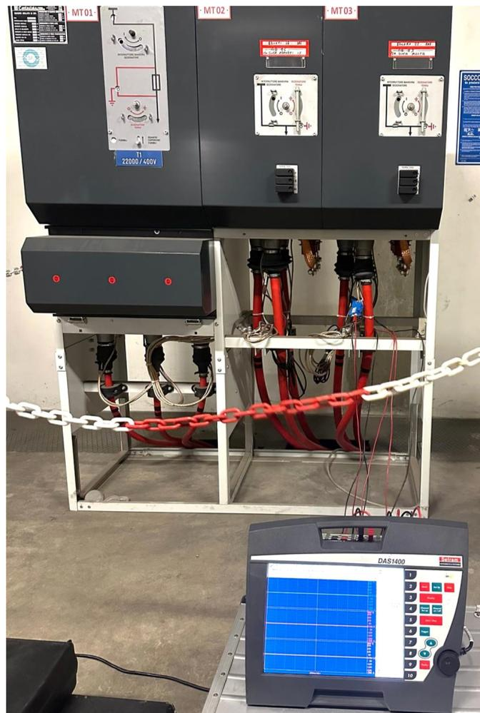
**Figura 5.3:** Schema di misura completo delle correnti negli schermi dei cavi MT presso cabina secondaria
