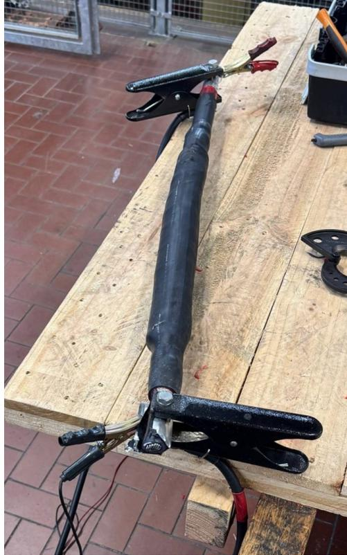
**Figura 5.10:** Misura della giunzione dello schermo del giunto sano appartenente alla linea Desana da Stura
