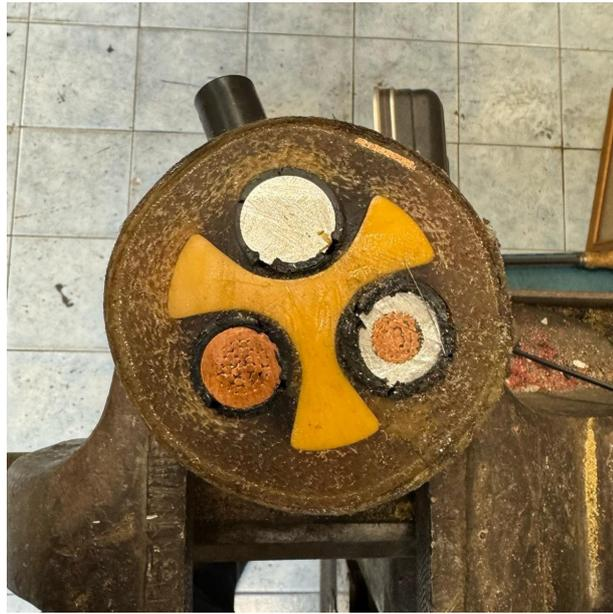
**Figura 4.11:** Giunto tripolare in carta impregnata
