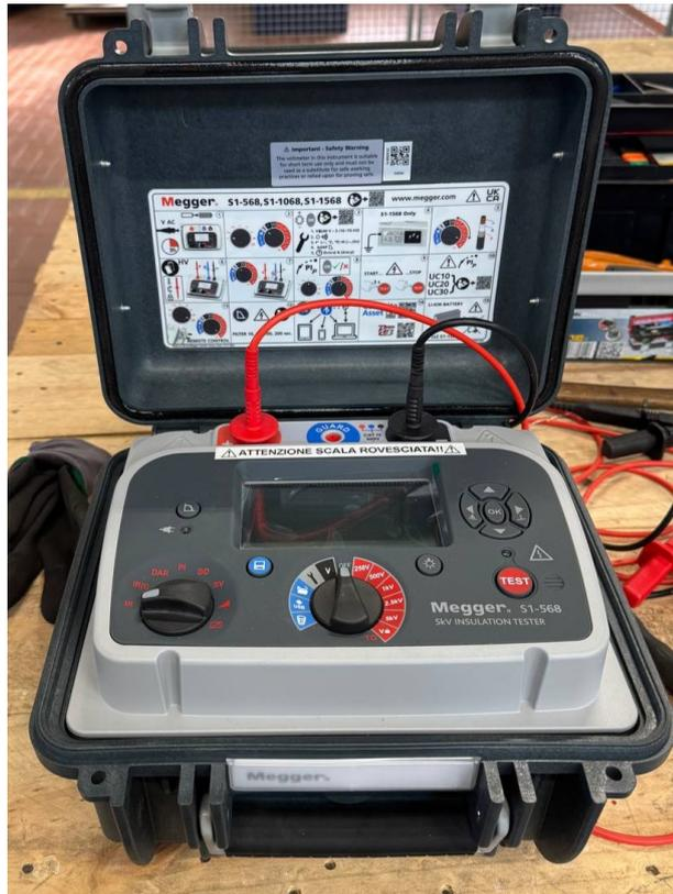
**Figura 5.8:** Tester di resistenza di isolamento
