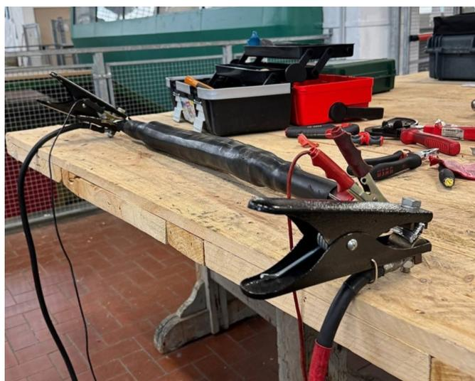
**Figura 5.11:** Misura della giunzione del conduttore del giunto sano appartenente alla linea Desana da Stura
