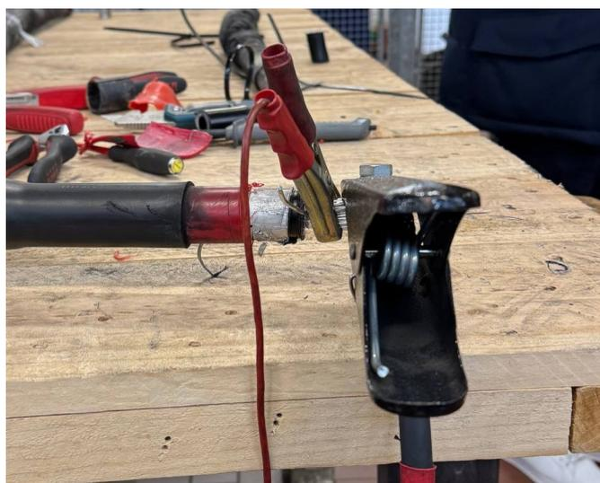
**Figura 5.12:** Misura della giunzione del conduttore del giunto sano appartenente alla linea Desana da Stura
