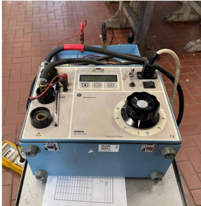
**Figura 5.7:** Micro-ohmmetro: misuratore di resistenza
