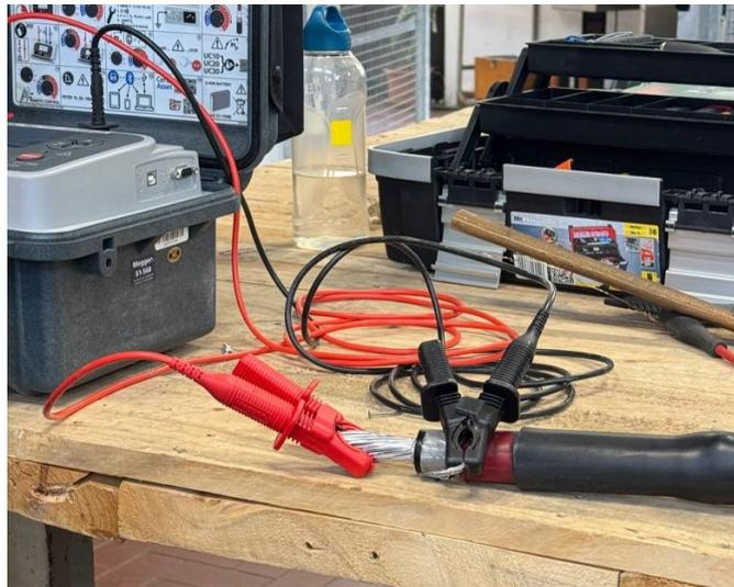
**Figura 5.13:** Misura della resistenza dell'isolamento del giunto sano appartenente alla linea Desana da Stura
