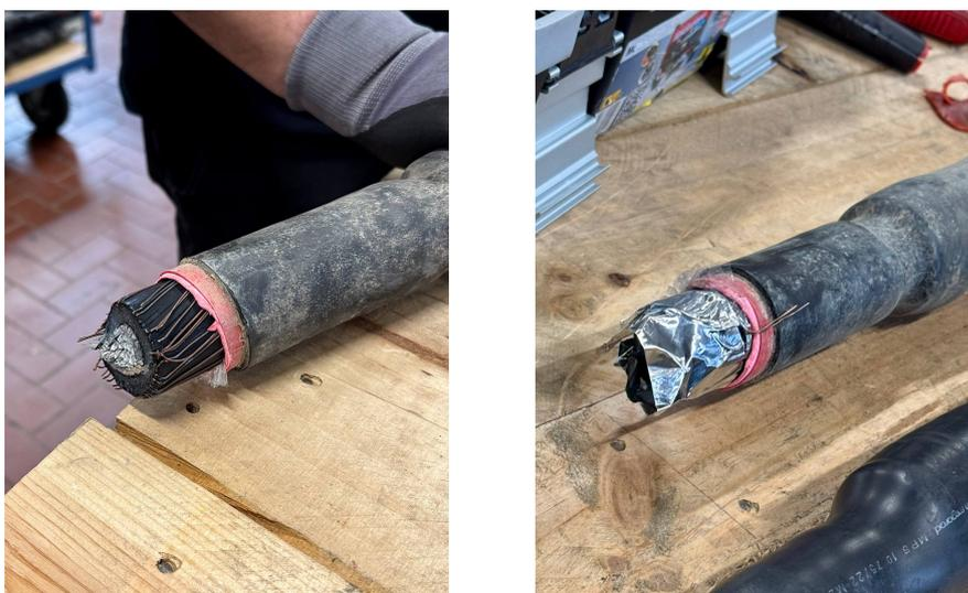
**Figura 5.15:** Estremità del giunto: Schermo a fili di rame senza e con nastro in alluminio conduttore
