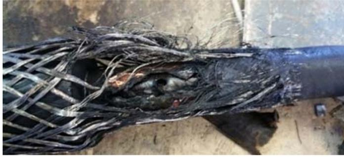
**Figura 3.10:** Guasto nel giunto del cavo interrato MT: tipico collegamento danneggiato tra la schermatura del cavo e lo schermo di giunzione [41].
