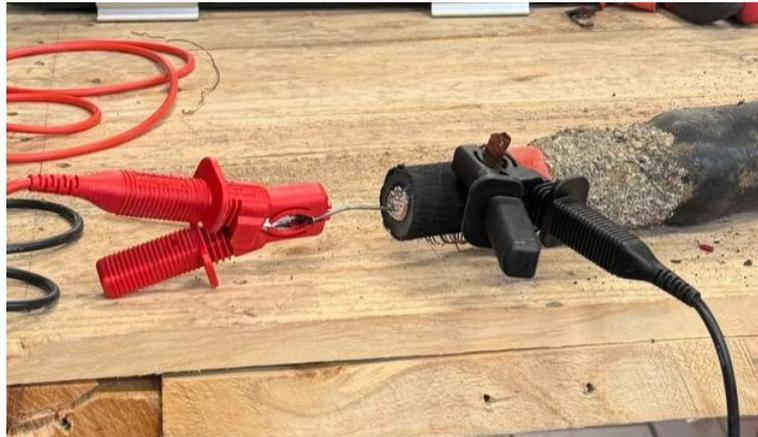
**Figura 5.20:** Misura della resistenza dell'isolamento del giunto sano appartenente alla linea 7074
