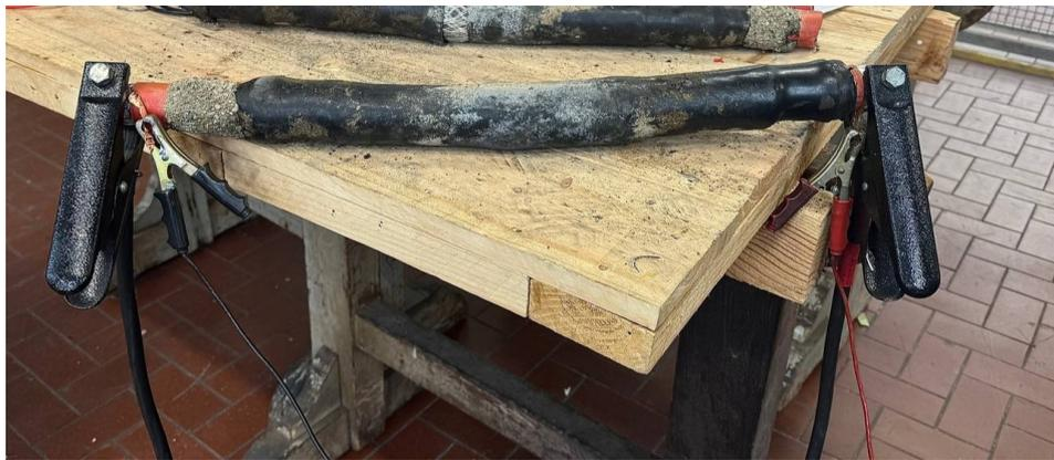
**Figura 5.19:** Misura della giunzione dello schermo del giunto sano appartenente alla linea 7074
