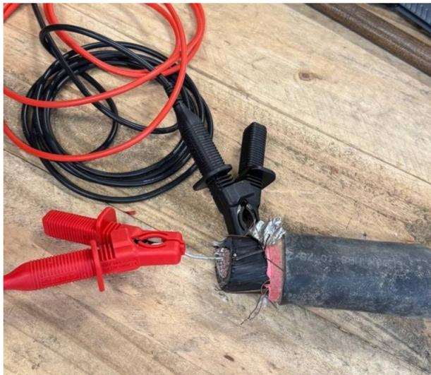
**Figura 5.17:** Misura della resistenza dell'isolamento del giunto appartenente alla linea Padova da Stura
