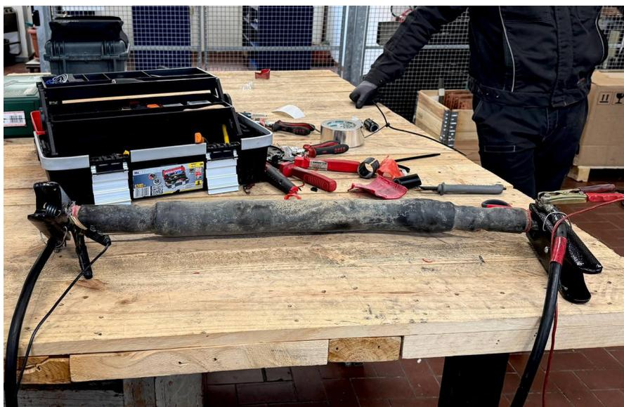
**Figura 5.16:** Misura della giunzione dello schermo del giunto sano appartenente alla linea Padova da Stura
