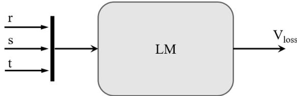
Figura 2.9: Macro schematico di una mappa di perdita per un motore elettrico
