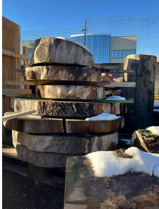
Fig. 7: essiccazione naturale di tavole segate in senso trasversale
