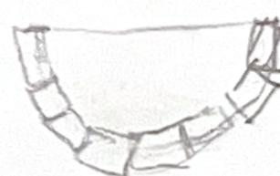
**TRAVE** (nr. 1): una trave metallica di supporto ricavata tramite **estrusione e saldatura** degli estremi. Fissata alle due gambe laterali, essa permette di reggere il portavasi e rendere la struttura portante più resistente.
