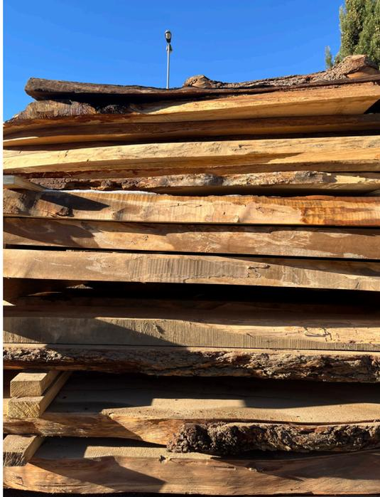
Fig. 6: essiccazione naturale di tavole segate in senso tangenziale
