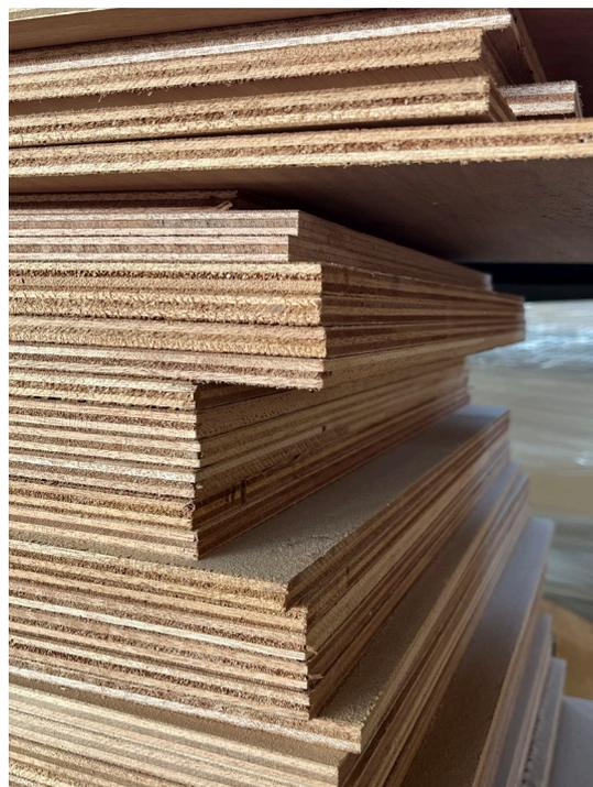
Fig. 19: pannelli di compensato
