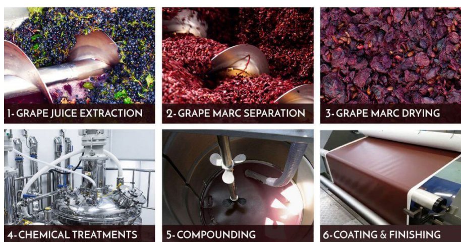
Immagine 5.19 - Fasi di produzione della pelle Wineleather. Fonte: video youtube "Wired Next Fest 2017 - BNL Square WNF 2017 - Wineleather, pelle ecologica creata dal vino"
