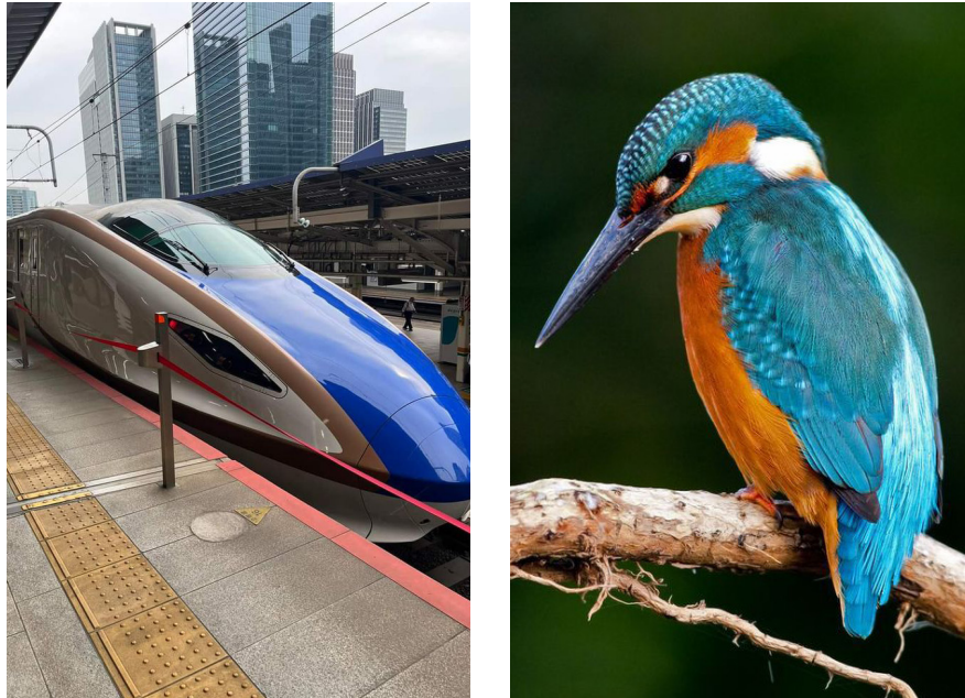
[Fig. 1.29] Il muso del treno Shinkansen riprende per la forma il becco dell'uccello martin pescatore conferendogli maggiore aerodinamicità e risolvendo il problema del rumore.
