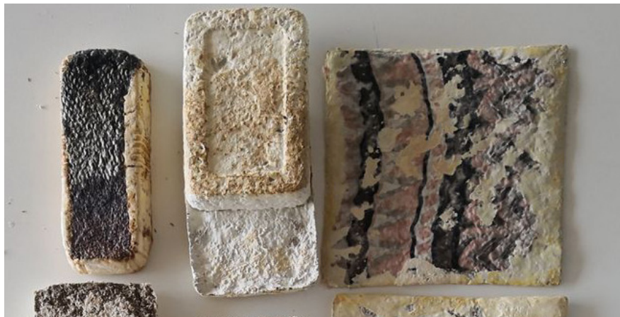
[Fig. 1.4] Biofabbricazione di un materiale a partire dal micelio.
