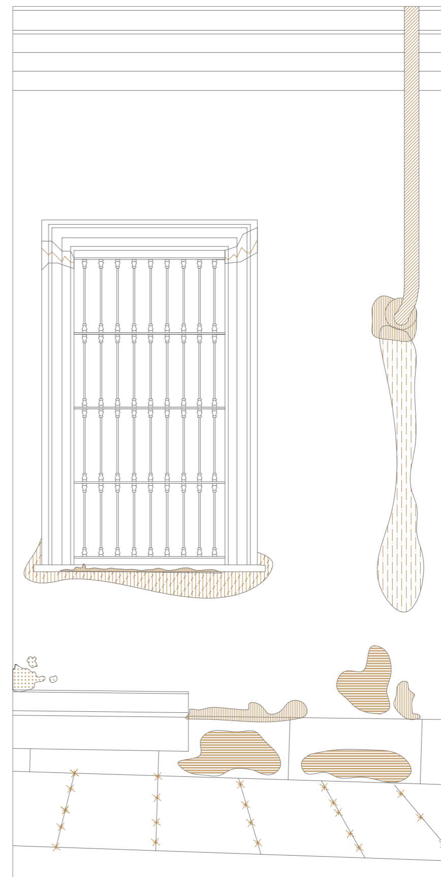
fig. 15 Scheda di una porzione dell'edificio novecentesco e mappatura del degrado, confronto con la Normativa
