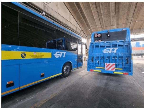
Figura 17: Rastrelliera posteriore per le bici montata su un Crossway di Iveco Bus
