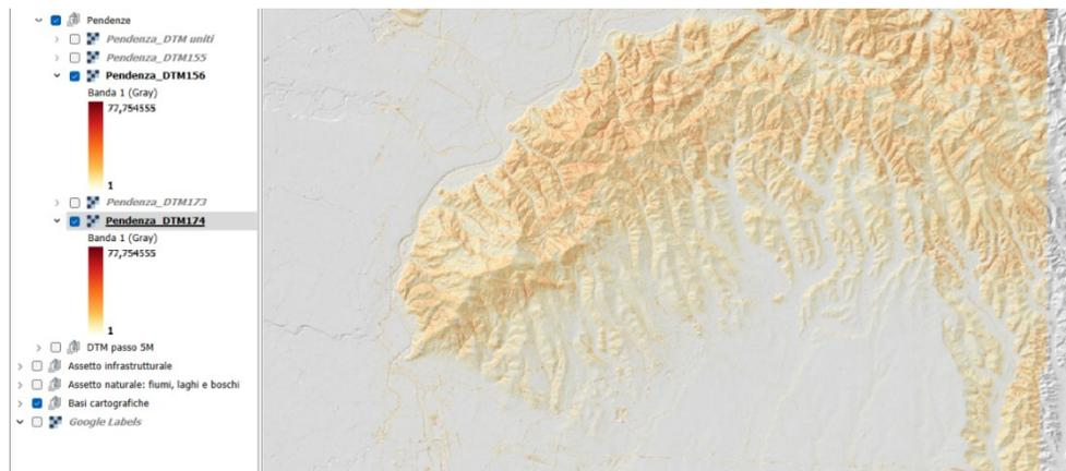
Figura 55: Schermata QGIS a seguito del calcolo della pendenza del terreno.
