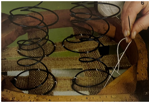
Fig. 18 Cucitura delle molle sulle cinghie
