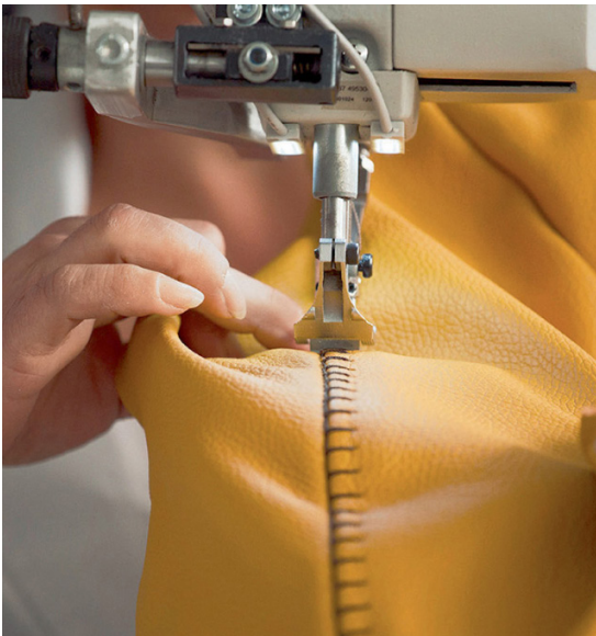
Fig. 42 Cucitura rivestimento in pelle
