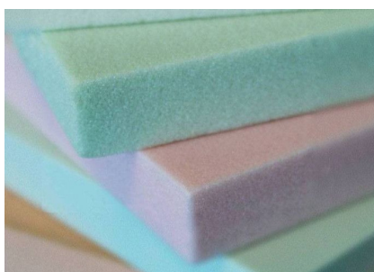
Fig. 28 Poliuretano espanso a diverse densità
