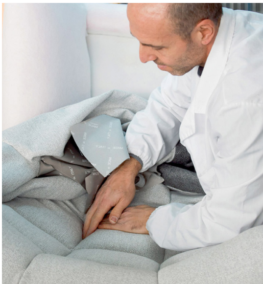
Fig. 43 Assemblaggio dell'imbottitura e del rivestimento sul fusto
