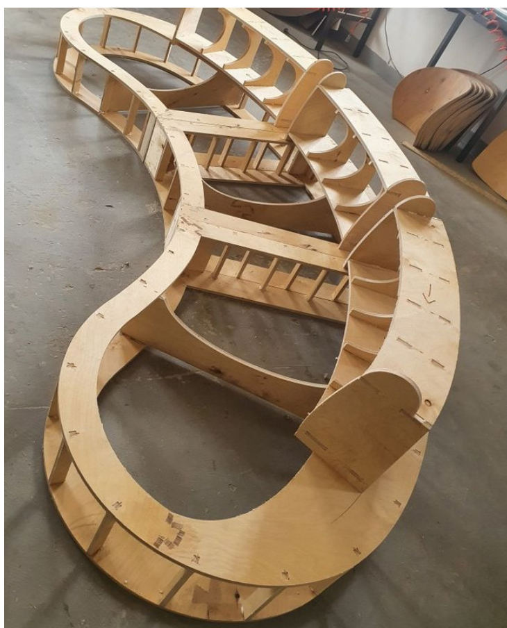
Fig. 14 Telaio di un divano dalle forme curve realizzato in legno multistrato
