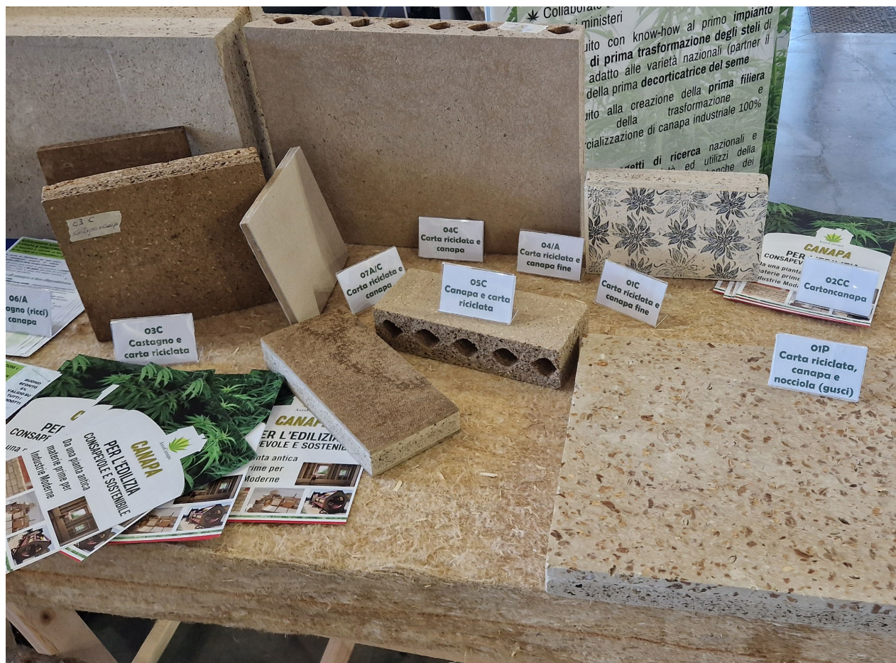
Fig. 38 - Vari pannelli con canapa per l'edilizia, allo stand di Assocanapa al salone Restructura di Torino - Foto propria, 2024
