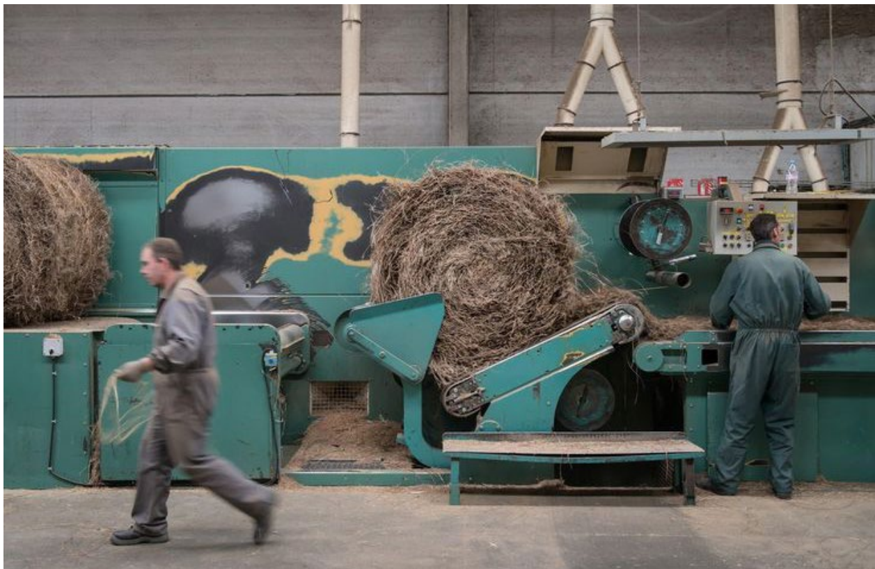
Fig. 81 - Srotolamento delle rotoballe, Foto di EMBRIN Normandie
