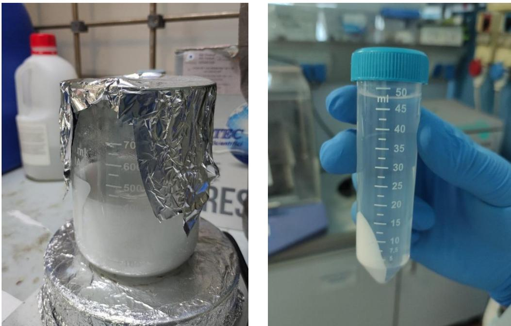
**Figura 3.4 a)** Soluzione opacizzata, **b)** Soluzione dopo la centrifugazione, in cui si nota la separazione delle fasi
