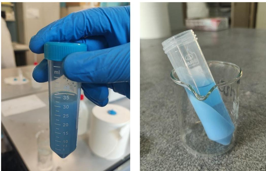
**Figura 3.6** a) Sospensione prima della centrifugazione, b) Fasi separate in seguito alla centrifugazione
