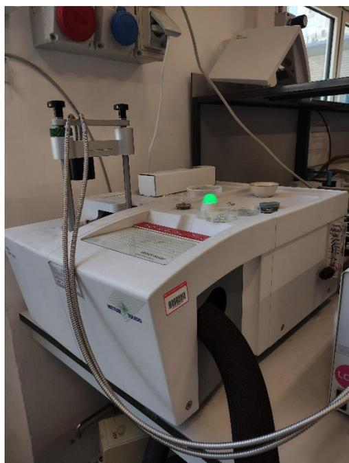
**Figura 3.13:** Strumentazione necessaria per le analisi Foto-DSC
