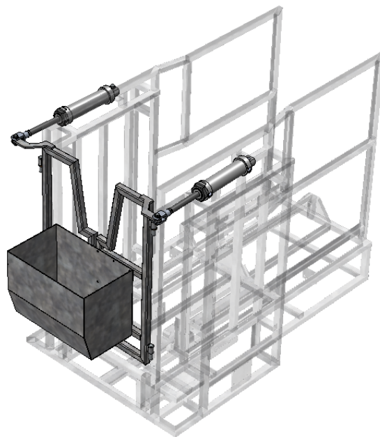
Figura 6.13: Fase di chiusura della porta anteriore
