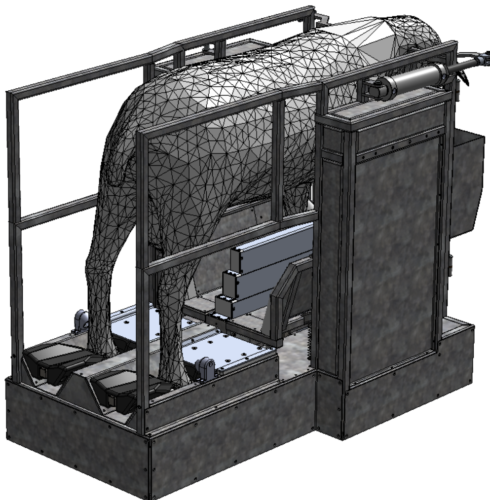
Figura 6.2: Vista posteriore del modello CAD completo della postazione di mungitura
