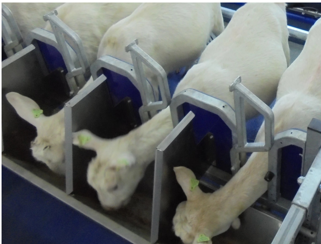
Figura 2.6: Particolare del meccanismo di immobilizzazione del collo applicato alla mungitura dei caprini. Fonte: www.delaval.com
