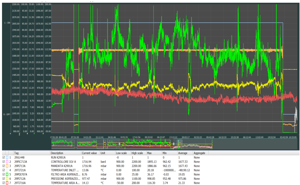
Fig. 4.1.2.4 Trend dei parametri di progetto del compressore
