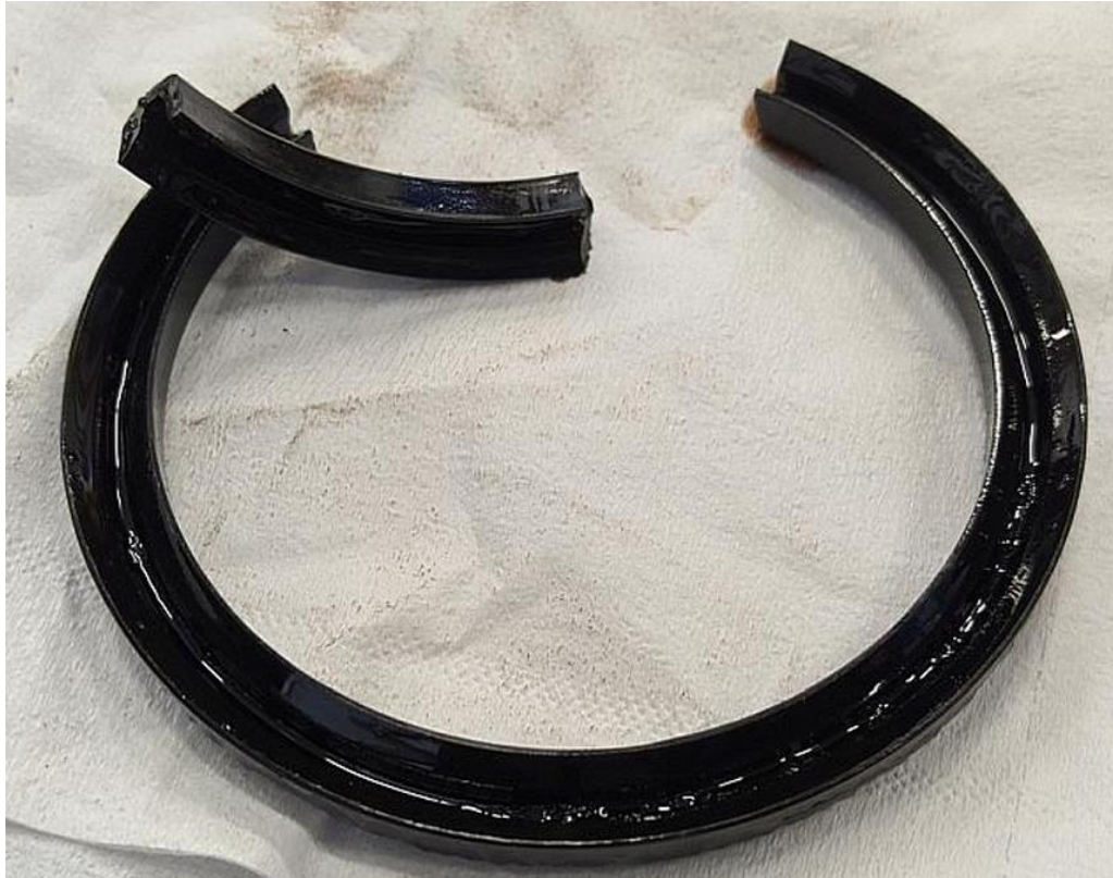
Fig. 4.3.4.4: a) anello stazionario con rottura nella zona del pin antirotazione e danneggiamento della faccia con scheggiatura; b) anello rotante con presenza di tracce violacee di surriscaldamento; c) guarnizione (u-cup ring) che ha perso elasticità per via della scarsa lubrificazione ed eccessiva temperatura
