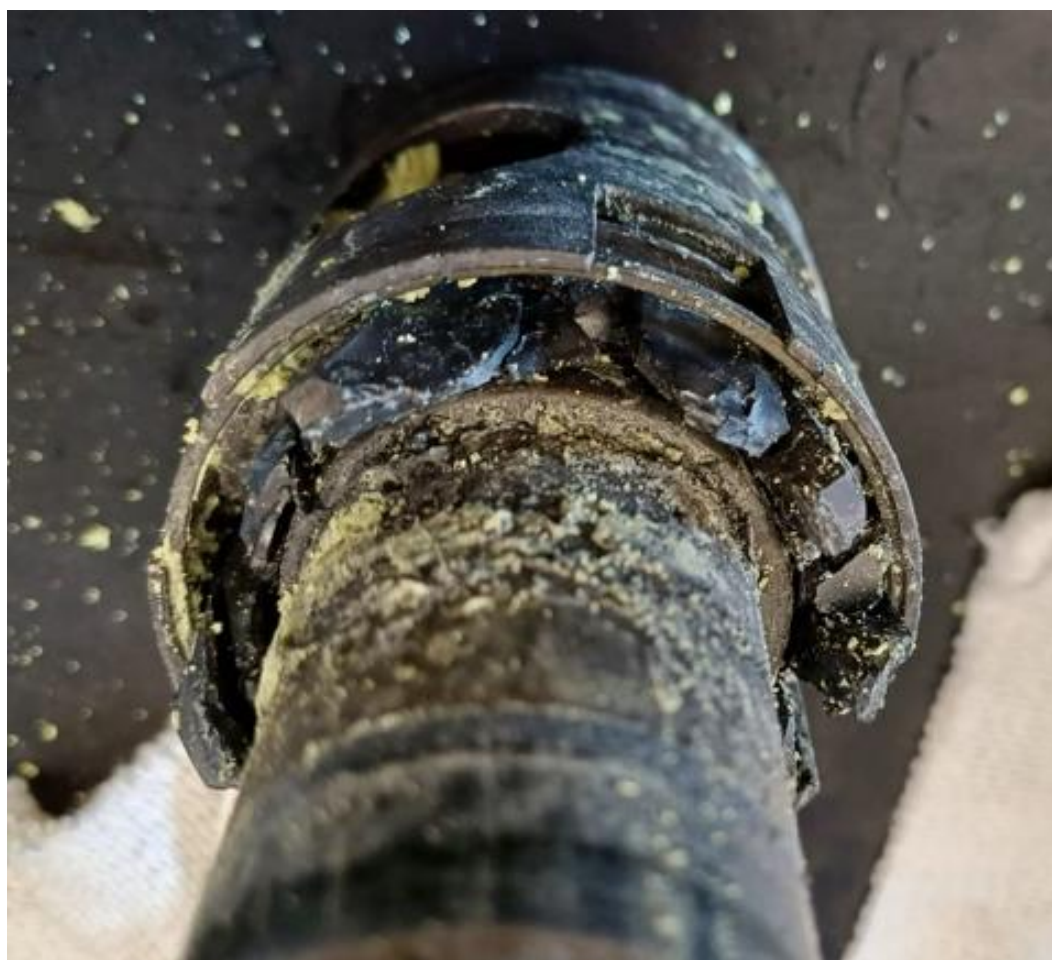
Fig. 4.1.4.2 Rottura della tenuta (della guarnizione in alto e dell'anello in basso)
