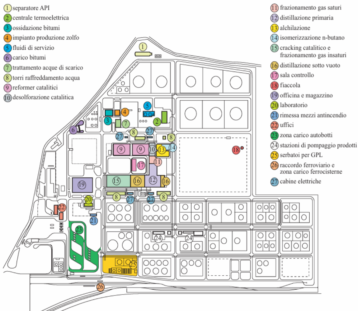
Fig. 1.3.1 Tipica disposizione planimetrica di una raffineria della seconda metà del Novecento
