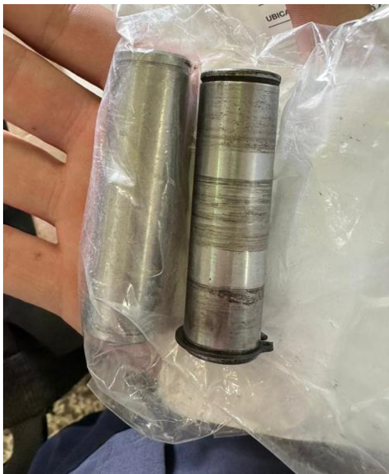
Fig. 4.4.4.3 Spinotto del cilindro danneggiato per usura
