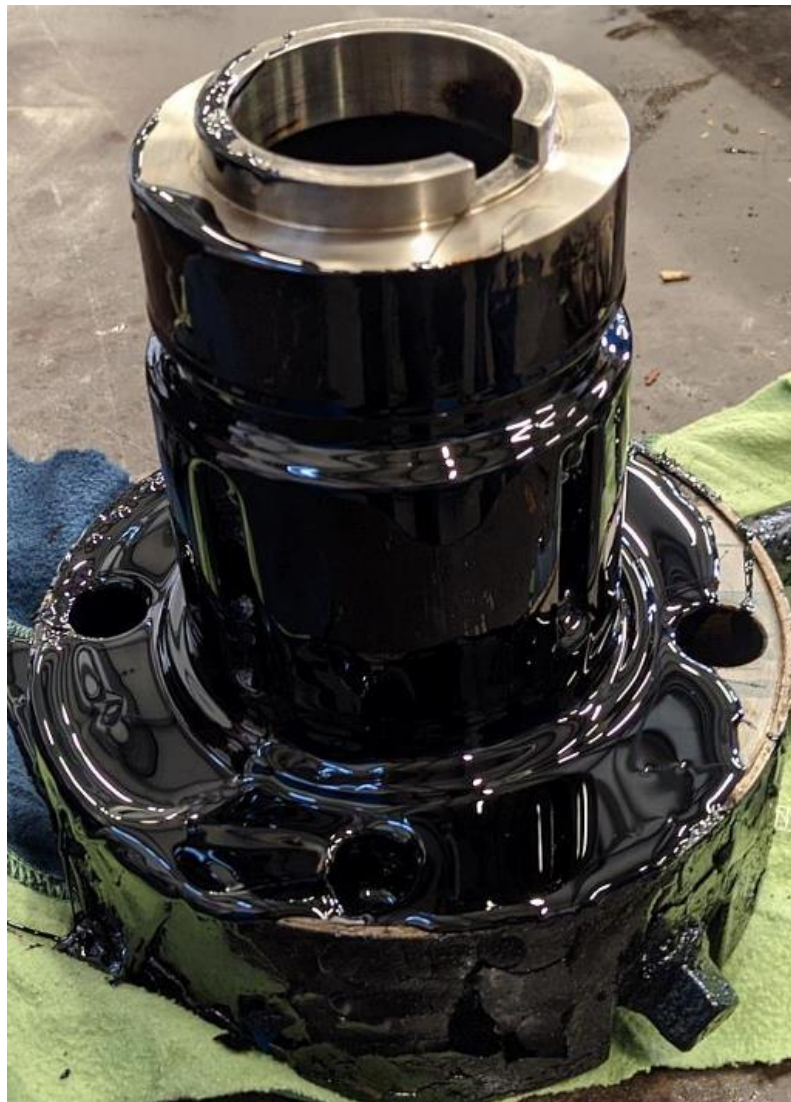
Fig. 4.3.4.3 Tenuta completa con sversamento di residuo molto viscoso
