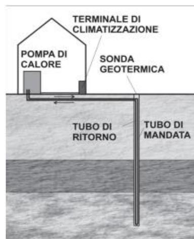
Figura 6 - Schema di un impianto geotermico a circuito chiuso con sonda geotermica
