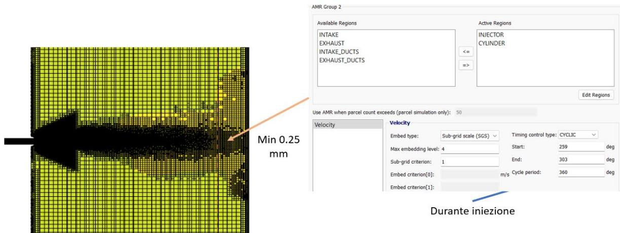
Figura 4.42: Esempio di AMR all'opera a seguito di iniezione (Geom. Uniflow)
