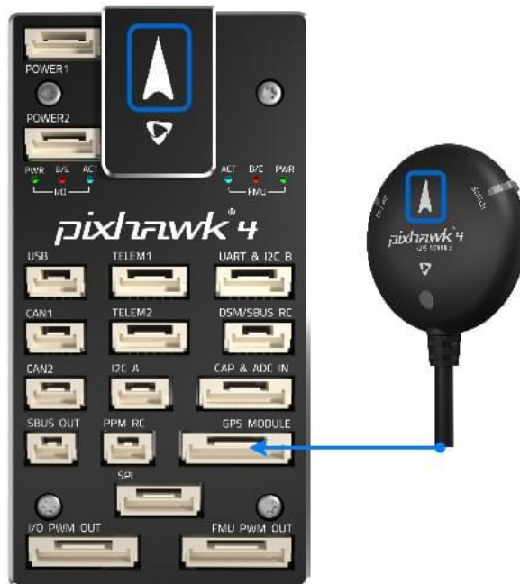
Figura 10: Modulo GNSS e connessione con il flight controller
