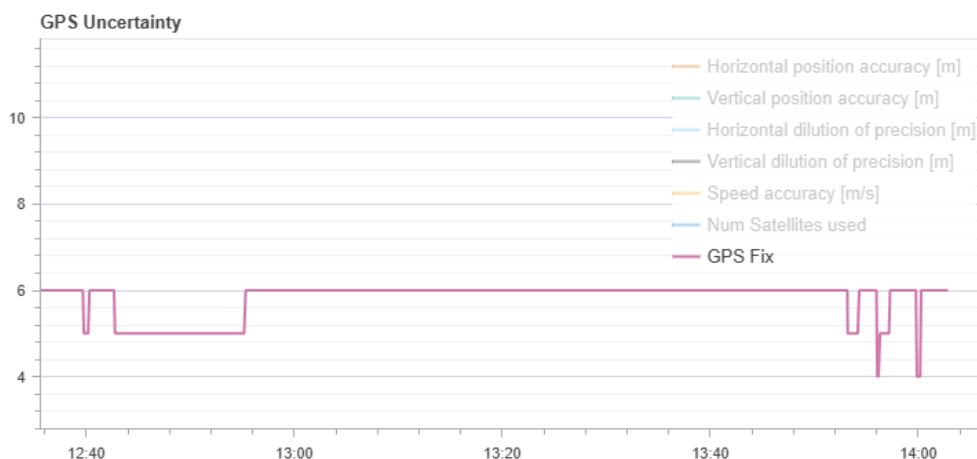
Figura 65: Instabilità del GPS fix con Spin3
