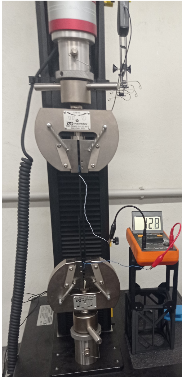
Figura 4.19: Setup Prova di Posizione
