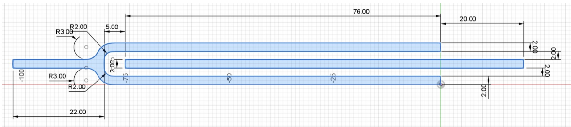
Figura 4.15: Dimensioni Sensore Posizione
