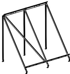
Kit di fissaggio per tetto piano o inclinato nella versione verticale, con struttura in alluminio.
