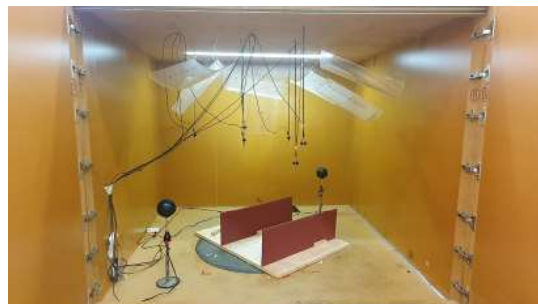
Fig 5.4.3.1.5 Camera riverberante con i baffle in conformazione A posti con interasse massimo, 37,25 cm
