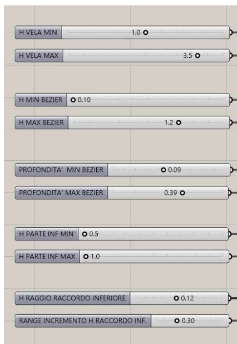
Fig. 5.3.1.8 Comandi slider di Grasshopper relativi ai valori quantitativi di fattore di forma proporzionale dei baffles
