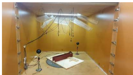
Fig 5.4.3.3.3 Camera riverberante con i baffle in conformazione C posti con interasse minimo, 10,25 cm
