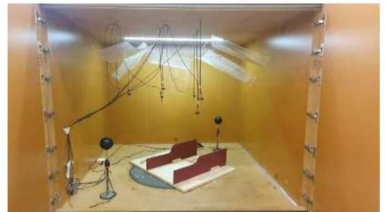
Fig 5.4.3.2.4 Camera riverberante con i baffle in conformazione B posti con interasse massimo, 37,25 cm
