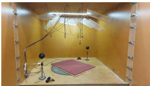
Fig 5.4.1.2 Prova 0 Camera riverberante con il materiale posto tradizionalmente sul provino in legno con una sola faccia esposta
