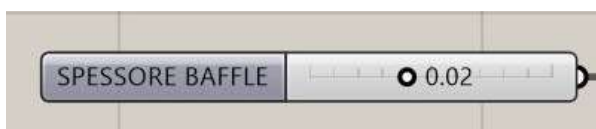
Fig. 5.3.1.17 Comando slider di Grasshopper relativo al valore di lunghezza dell'estrusione delle superfici dei baffles
