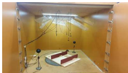
Fig 5.4.3.3.4 Camera riverberante con i baffle in conformazione C posti con interasse massimo, 37,25 cm
