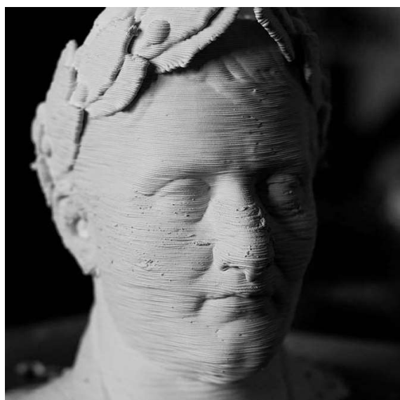
Fig. 5.2.3 Stampa del busto di Napoleone realizzato con estrusore per stampa ceramica www.3dwasp.com
