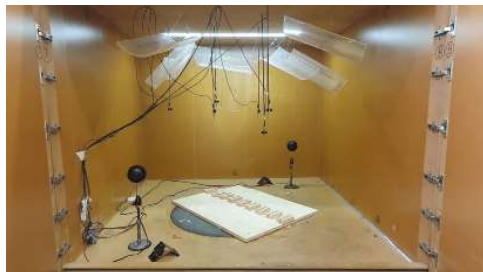
Fig 5.4.1.1 Prova preliminare in camera riverberante del provino vuoto in legno che ospiterà le configurazioni dei baffles
