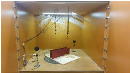
Fig 5.4.3.1.4 Camera riverberante con i baffle in conformazione A posti con interasse minimo, 10,25 cm
