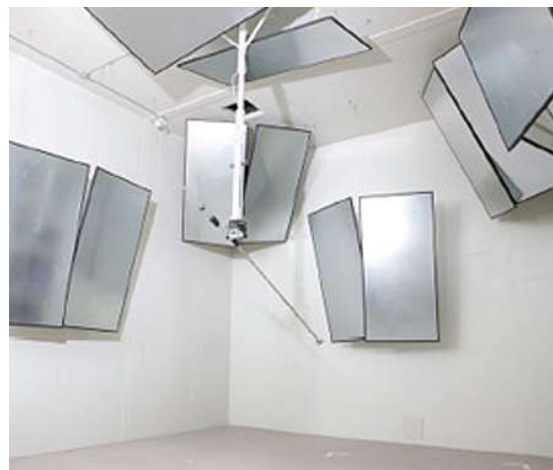
Fig 1.1.1.2 Camera riverberante TS-Lindgren, i pannelli riflettono i suoni per creare un campo sonoro non direzionale o diffuso all'interno della camera. www.ets-lindgren.com
