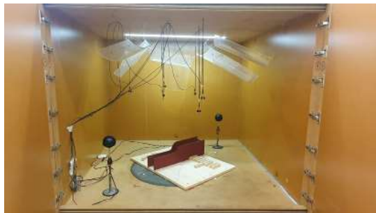
Fig 5.4.3.2.3 Camera riverberante con i baffle in conformazione B posti con interasse minimo, 10,25 cm
